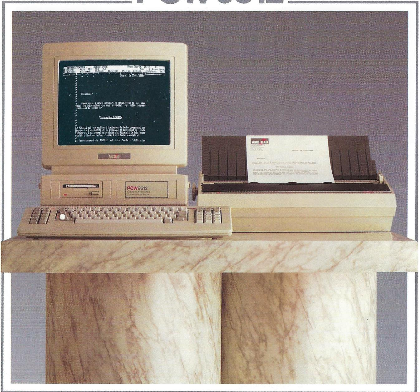
Le PCW 9512 "Direction" est le dernier-né des systèmes de traitement de texte Amstrad. Il est équipé d'un clavier ergonomique, d'un moniteur haute résolution noir et blanc, d'un lecteur de disquettes 3" de 720 Ko et d'une imprimante à marguerite
