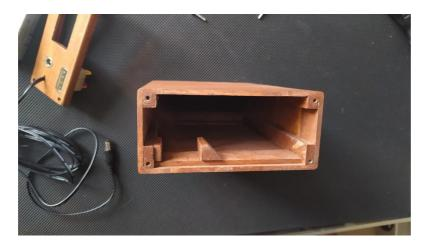
FR Le truc, c'est qu'à l'intérieur de la boîte, j'ai coupé et collé les lattes aux coins intérieurs pour garder le lecteur de disquette droit et visser le couvercle arrière en place. J'ai fixé des supports sur les côtés et à l'arrière de la prise molex, qui sera utilisée comme entrée 5 volts et 12 volts, pour la maintenir stable lors du branchement et du débranchement.
