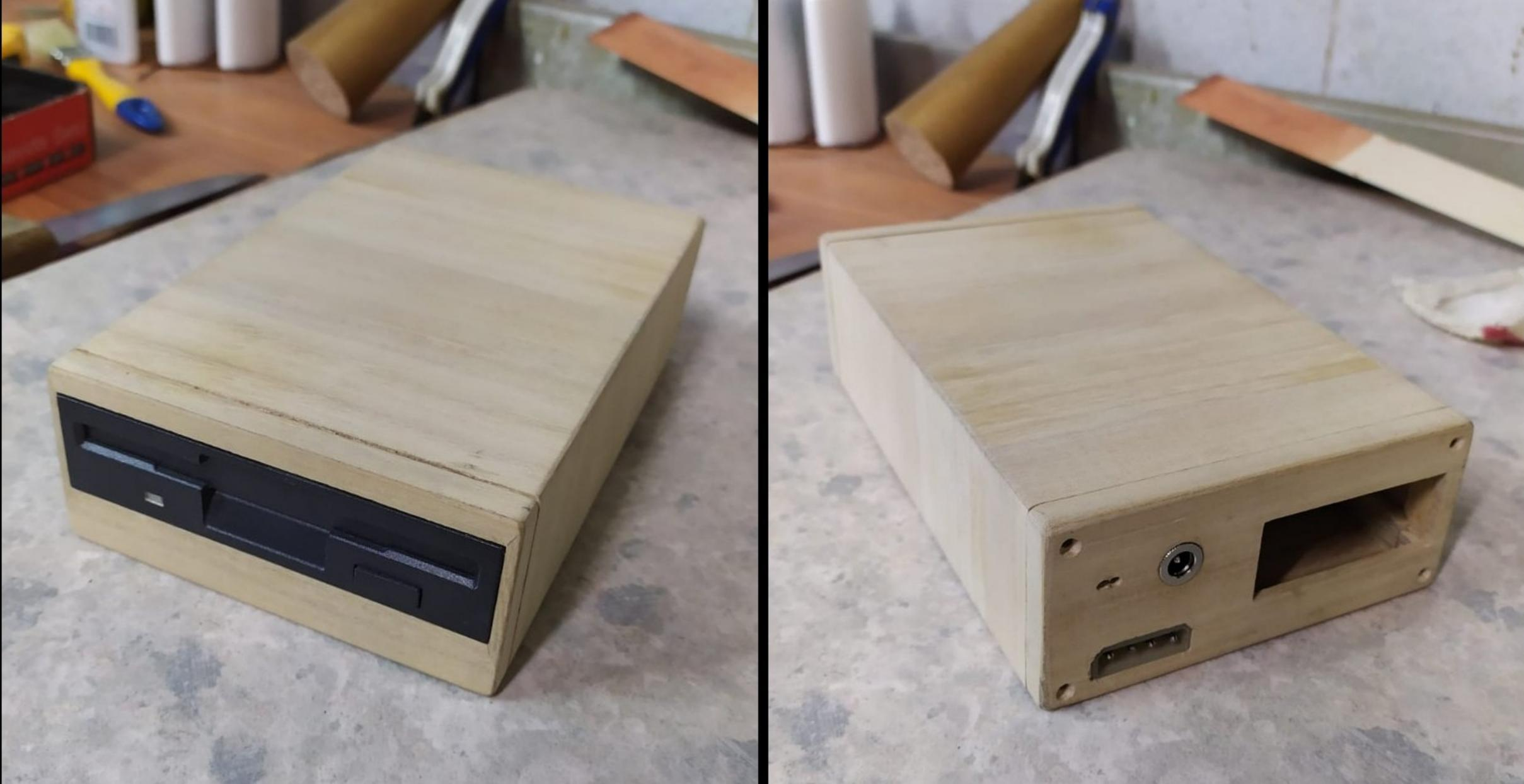
Esas olay kutunun iç kısmında, disket sürücünün düzgün durması ve arka kapağın yerine vidalanması için iç köşelere uygun ölçüde çıtalar keserek yapıştırdım. 5 volt ve 12 volt girişi olarak kullanılacak olan molex sokete fiş takıp çıkarırken sabit durması için yanlarına ve arkasına destekler yapıştırdım.
