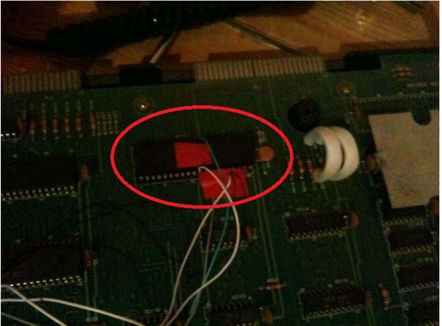
Les pattes sont numérotées sur le PCB de l'ordinateur pour s'y retrouver facilement. Pour le 74LS32 qui n'est pas numéroté, le principe de numérotation est le même, comme sur tous les circuits intégrés : on part du détrompeur, et on compte dans le sens inverse des aiguilles d'une montre. Comme ci-dessous :
