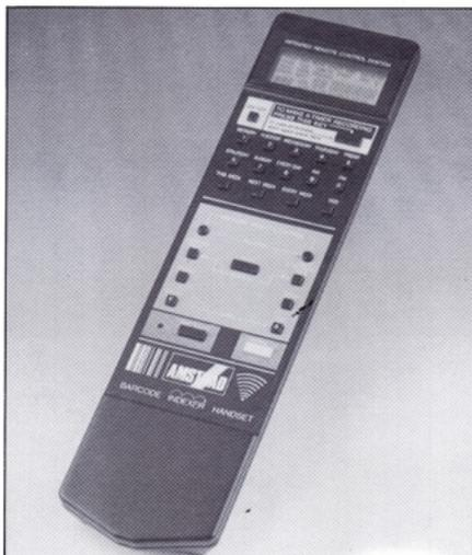
El mando permite una programación automática pasando el extremo, (scanner), por los códigos.
