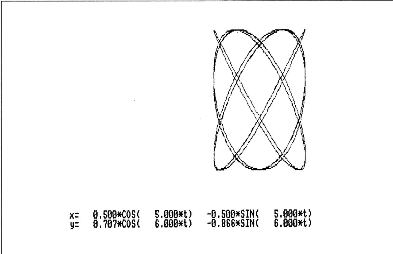
Fig. 4 : Lissajous sur signaux sinusoïdaux bizarres.
