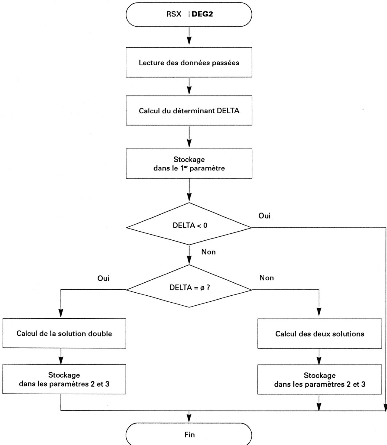
L'en-tête du programme précise le mode d'appel de la RSX, les paramètres en entrée et en sortie.
