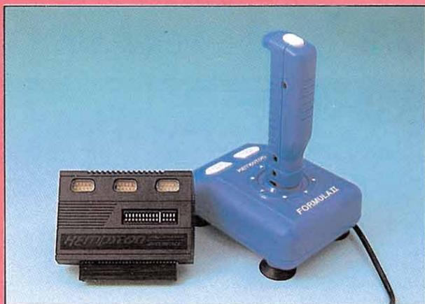
Así mismo, es compatible con cartuchos de ROM y el software de cassette. Kempston Pro interface es compatible con joysticks de Atari y Commodore, aunque especialmente diseñado para este interface aparece el joystick Fórmula 2.
