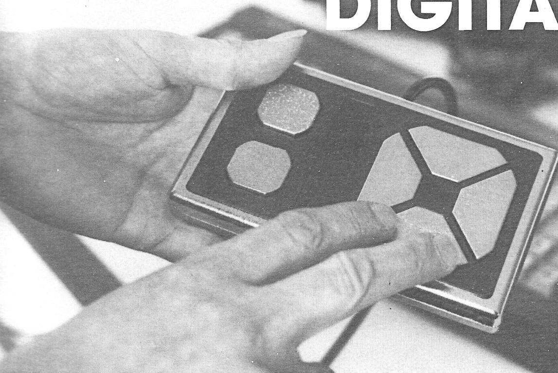
***Il nous vient d'Italie : Flashfire est le premier joystick à réagir aux propriétés capacitives du corps humain. La touche à effleurements est depuis longtemps utilisée dans les ascenseurs pour déclencher en douceur les appareils photos. La voici désormais sur un joystick. Fini les micro-switches cliquetants et les tiges en acier trempé ! Et tant pis pour les hargneux de la baston (stick) de joie (joy) !***
