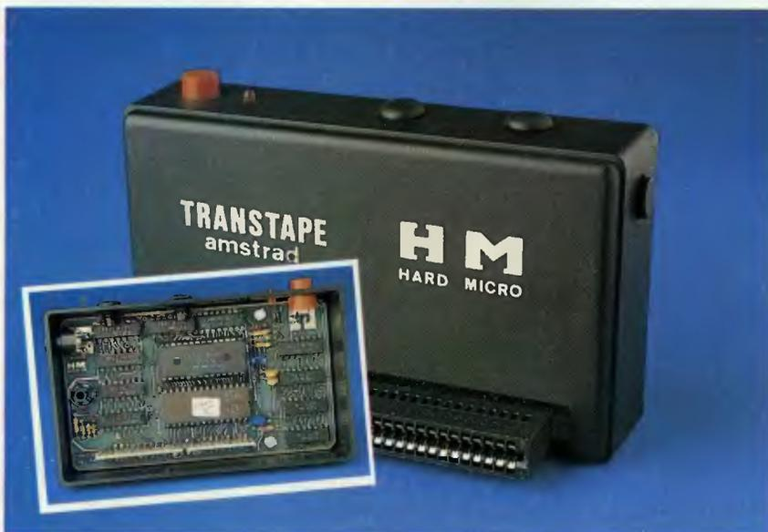
**E**L transtape externamente está compuesto por cuatro partes bien diferenciadas: dos pulsadores (uno de color negro, que es el reset, y otro de color rojo, que inicializa las funciones típicas del transtape), un led (indicador luminoso), que indica cuándo hemos activado el pulsador verde, y una continuación del port de expansión para permitir la conexión de otros periféricos.
