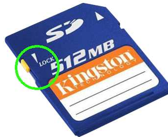
Figure 13 : Protection en écriture de la carte SD
