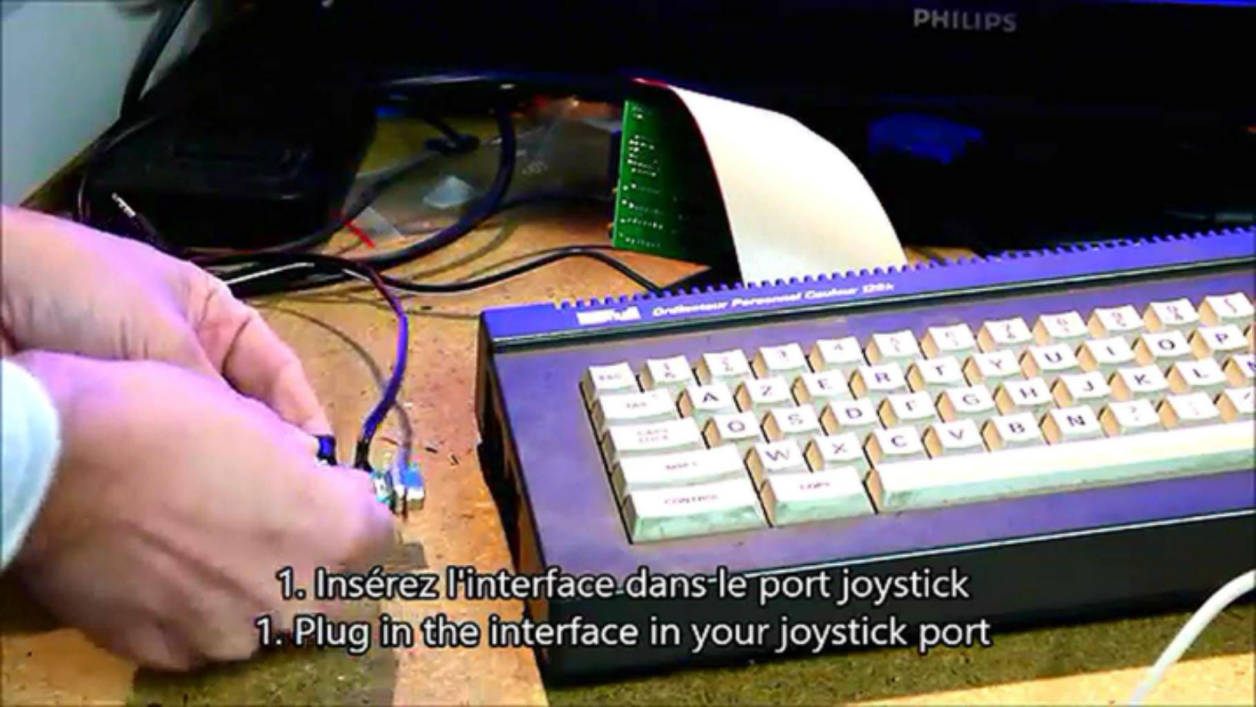
1. Insérez l'interface dans le port joystick
