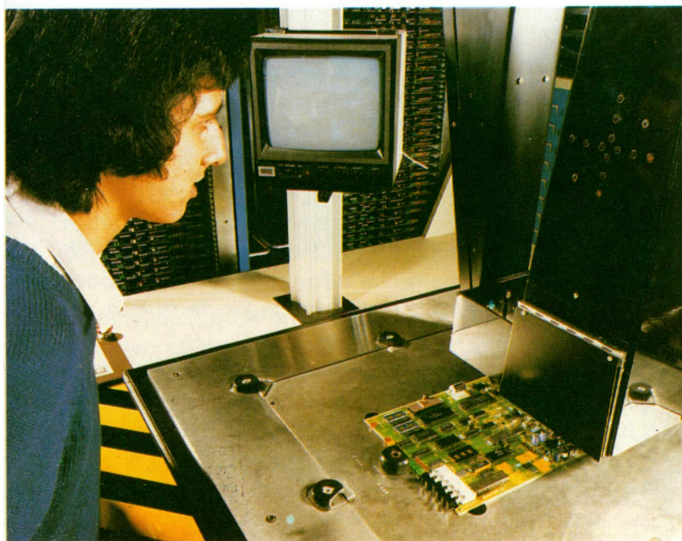
Método de MME Measurement Systems, destinado a explorar mediante un computador, y en un corto espacio de tiempo, los componentes que forman las tarjetas de circuito impreso. Este sistema compara los datos de la tarjeta bajo prueba, con los establecidos en la memoria por una tarjeta patrón.
