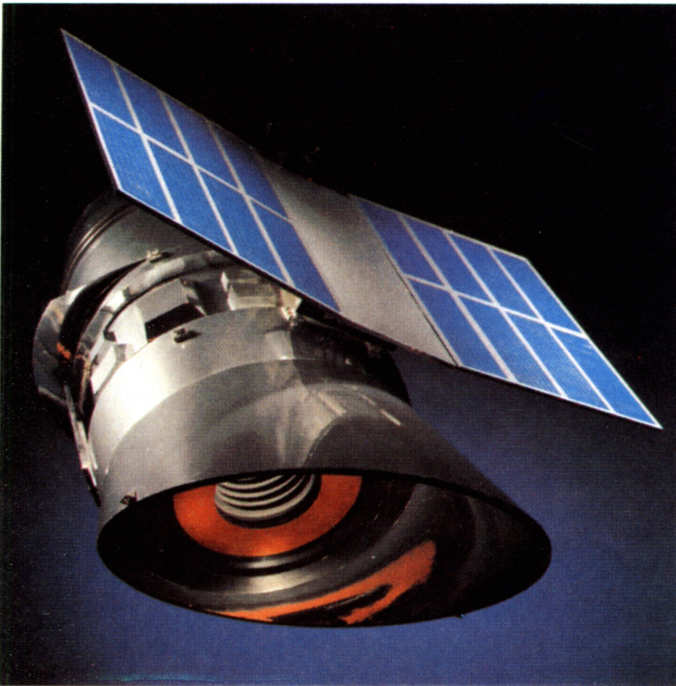
Este satélite científico alemán está preparado para explorar las fuentes de infrarrojos del espacio. Puede observarse la gran extensión de los paneles solares. (Cortesía: Philips).
