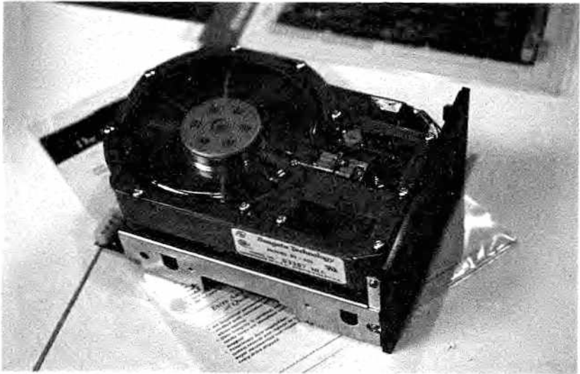
Foto 4 - Unidad de disco rígido en la que puede verse el disco al haber quitado la tapa.
