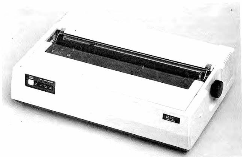
Foto 2 - Una de las últimas impresoras de agujas: la MicroL 93A de OKI.
