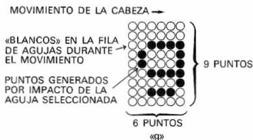
Fig. 4 - Cabeza de agujas (a) y matriz de puntos (b) que se puede emplear al desplazar la cabeza sobre su guía y accionar las agujas.
