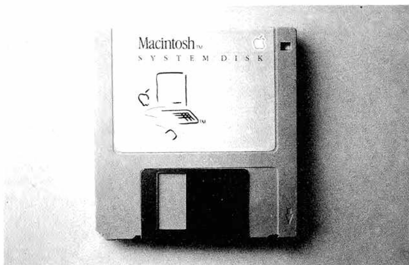
Foto 2 - Microdisco flexible de 3 pulgadas y media en cartucho de plástico.
