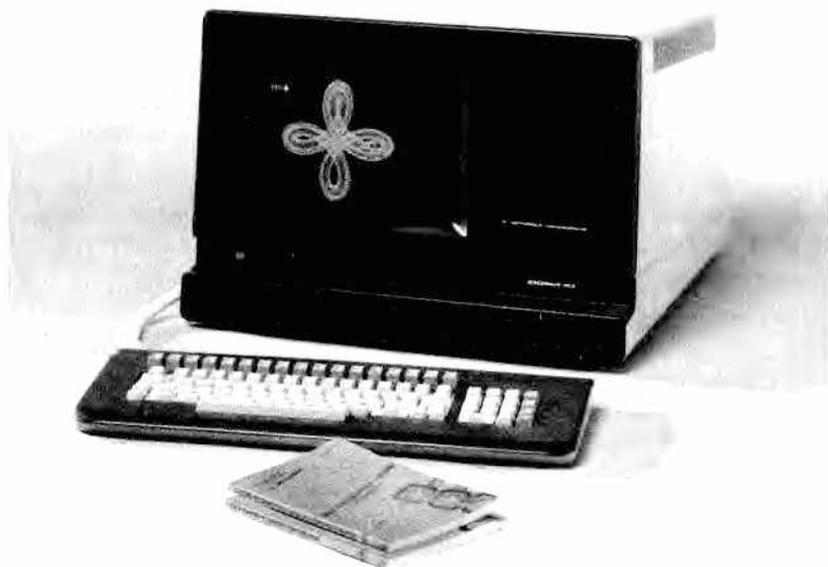
Fig. 5. Sistema en tiempo real EXORset-163 de Motorola dedicado a aplicaciones en tiempo real y a operaciones multitarea.
