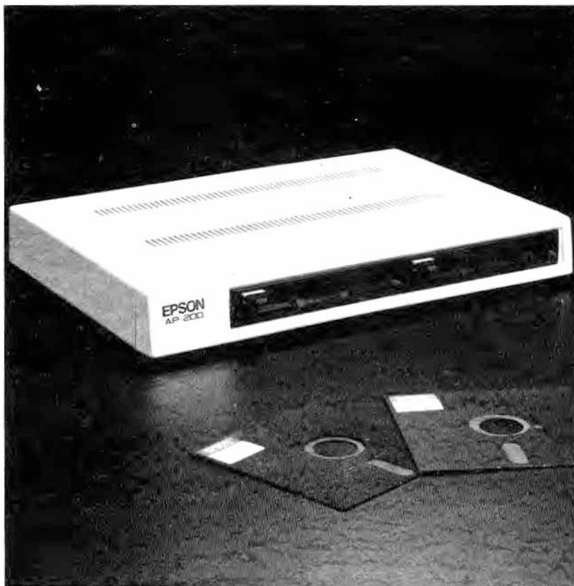
*Fig. 15. Unidad de disco doble, ultraplana, concebida para el ordenador Apple II.*
