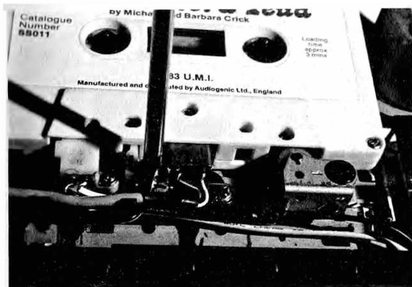
Figura 3.— Regulación de la alineación de una cabeza (azimut) con un destornillador.
