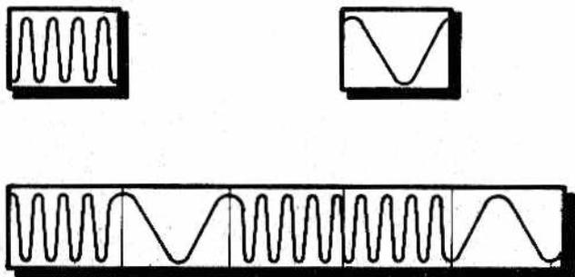
Figura 1.—Los valores 1 y 0 de los bits se almacenan como señales sinusoidales de frecuencia diferente.
