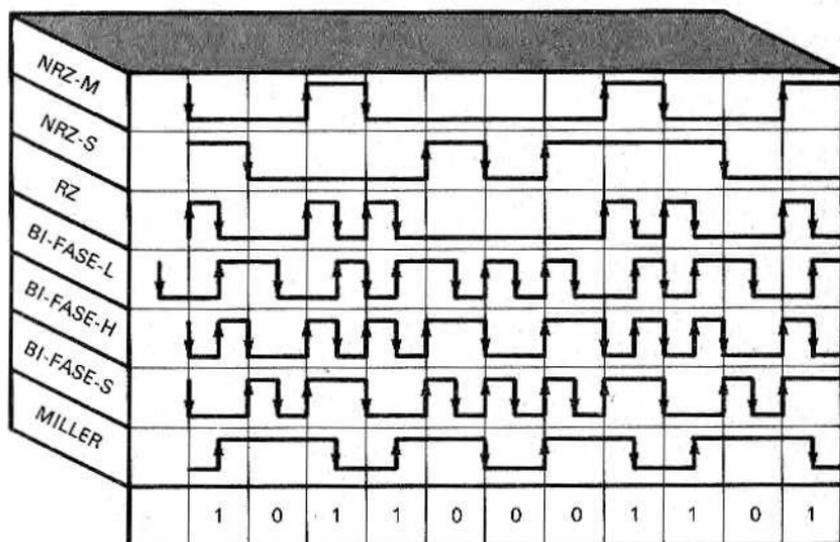
Figura 2.—Técnicas utilizadas en el almacenamiento magnético digital.
