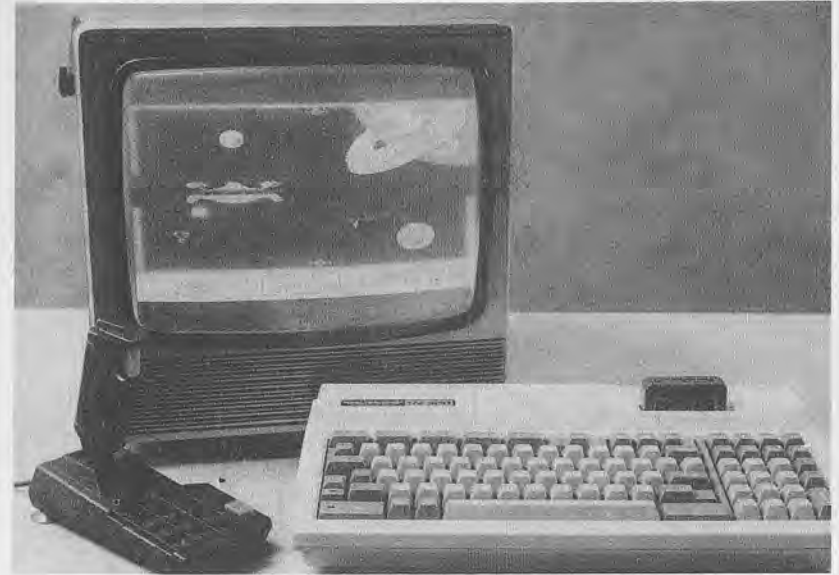
Figura 6.—Los vídeo-juegos hacen uso tanto de dispositivos de entrada (teclado, joystick, etc.) como de salida (normalmente la pantalla). Muchos de ellos se encuentran disponibles para ser usados en ordenadores domésticos, pero con otros sólo podremos jugar en máquinas especialmente diseñadas para ello, aunque básicamente no son otra cosa que ordenadores especializados.
