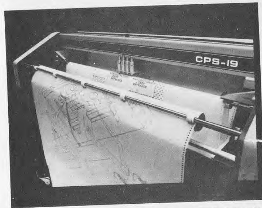
Figura 18.—En aplicaciones que exijan un gran tamaño de los dibujos se usan plotters como el de la figura.
