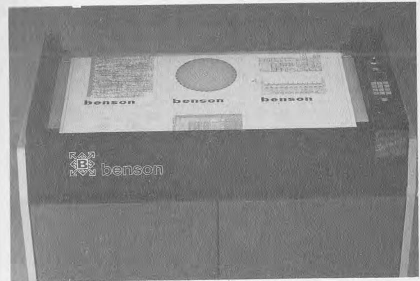
Figura 13.—Aspecto externo de un plotter de tipo electrostático.
