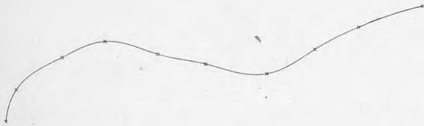
Figura 15.—Ejemplo de una curva tipo "spline". Se puede observar cómo pasa por todos los puntos que la definen.
