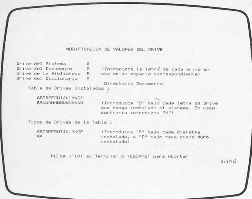
Figura 5.—Mediante esta opción informamos al MultiTexto de las unidades de discos disponibles, su tipo y los discos que usaremos en cada una.
