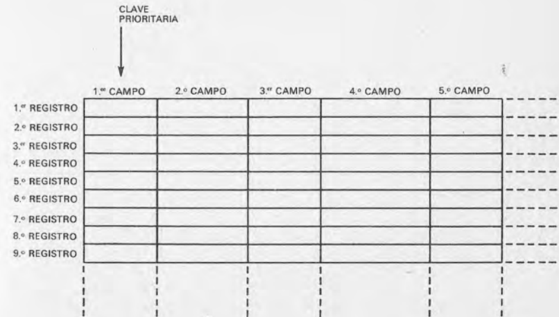
Figura 3.—Estructura aleatoria del fichero MASTER FILE.
