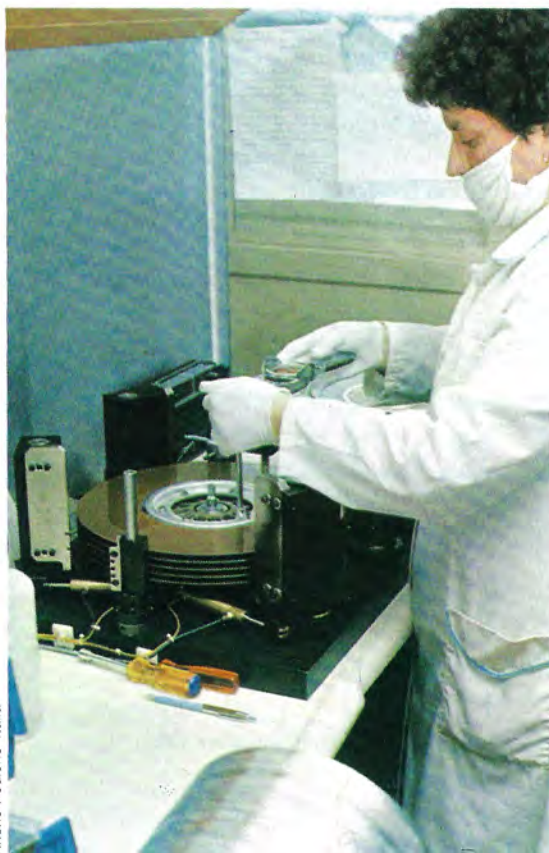
El equilibrado en dos planos confiere perfecta estabilidad a la fase de rotación de los discos en la unidad de disco.
