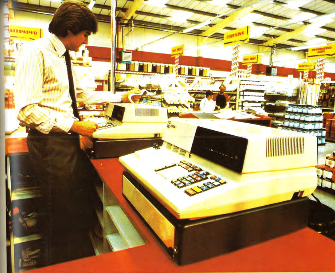
El microordenador se ha introducido en las cajas registradoras. Estas máquinas contienen un pequeño sistema completo, con CPU, memorias e interfaces I/O.
