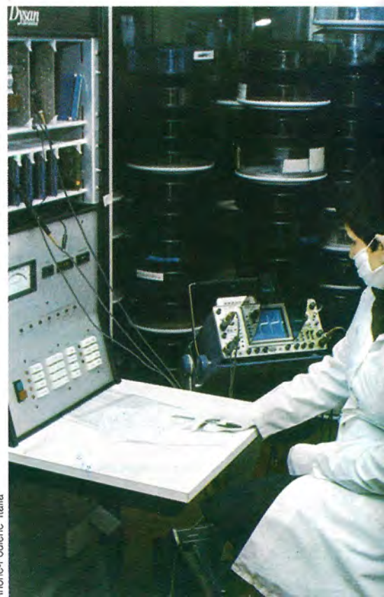
La verificación digital en unidad periférica garantiza la adaptación del paquete de discos al ordenador.
