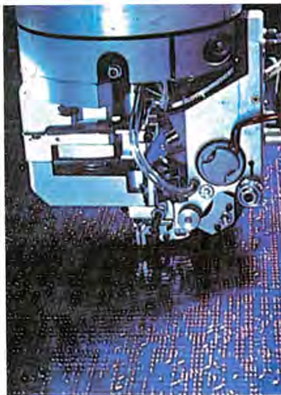
Soldadora-robot que opera sobre un panel.
