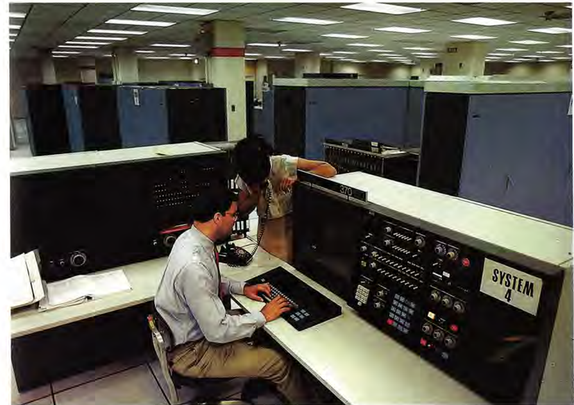
Sistema de cálculo IBM 370. En el centro puede verse al cuadro de monitorización del sistema de teletransmisión de datos.
