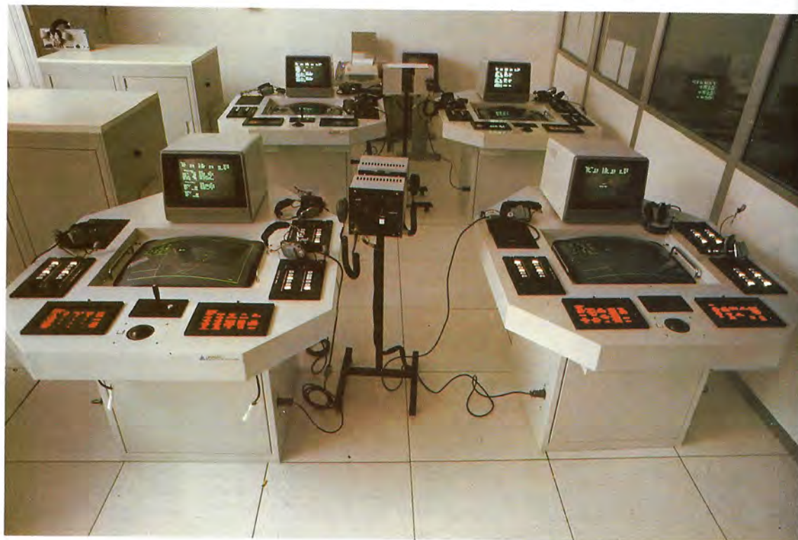
Equipo del centro de adiestramiento aeronaval de Tarento. Las consolas reproducen la situación de las centrales operativas de combate.
