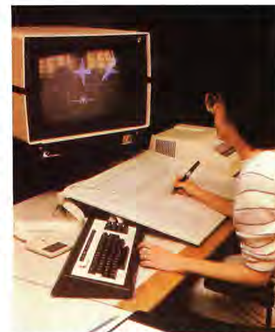
Empleo del lápiz óptico en el diseño asistido. La operadora está elaborando la imagen de un F15.
