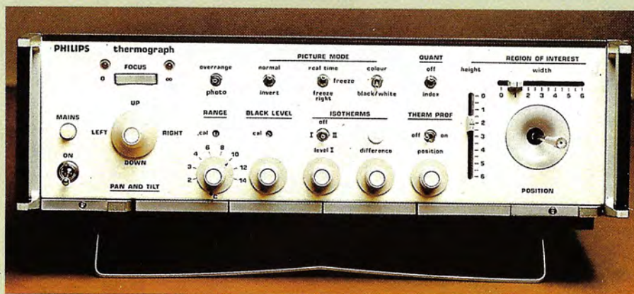
El panel de mando y de control de un aparato para la termografía de imágenes digitalizadas. A la derecha pueden verse el joystick de posicionado y los cursores de delimitación del campo de observación.
