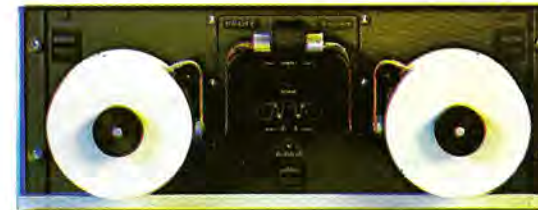
Diversas configuraciones del lector de cinta perforada Facit 4030. Arriba a la izquierda: configuración para la lectura de cintas que contienen menos de 8000 caracteres (unos 20 m de longitud); a la derecha: configuración para la lectura de cintas que contienen hasta 2000 caracteres (unos 50 m). Arriba a la izquierda: configuración para la lectura de cintas que contienen hasta 40.000 caracteres (100 m); a la derecha: configuración para la lectura de cinta plegada.
