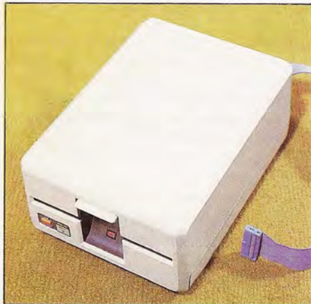
Una lectora de discos flexibles es capaz de leer y escribir datos con acceso directo en un soporte magnético. Estos soportes pueden llegar a almacenar del orden de varios centenares de Kbytes de información.
