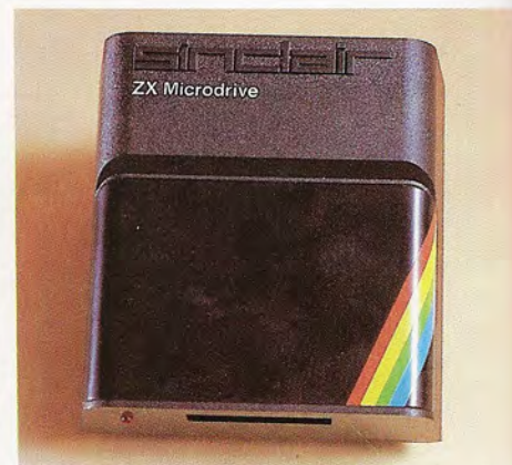
Unidad de micro-cinta magnética creada para el popular ZX-SPECTRUM.
