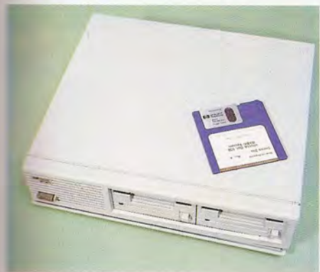
Las unidades de minidisco o microdisco flexible son periféricos de almacenamiento de características semejantes a las tradicionales unidades de disco flexible de 5 y 1/4 pulgadas, aunque ocupando menor espacio físico.
