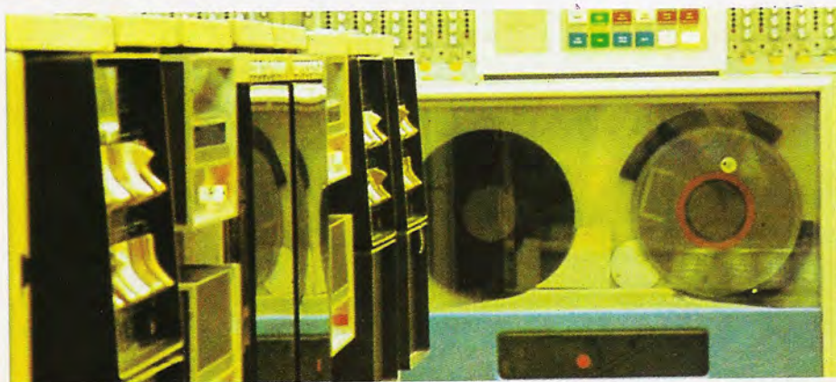
Las cintas magnéticas pueden llegar a almacenar grandes volúmenes de información. Al ser intercambiables y removibles se emplean con asiduidad en centros de proceso que manejan ingentes cantidades de datos.
