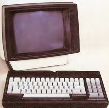
La consola o terminal es un periférico de comunicación integrado por un dispositivo para la entrada de información (teclado) y una unidad periférica de salida (pantalla).
