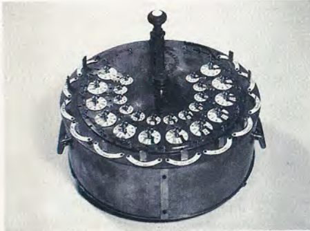
Calculadora diseñada y construida por Mattieu Hahn en 1779. Se estima que es la primera máquina de calcular capaz de realizar las cuatro operaciones aritméticas.
