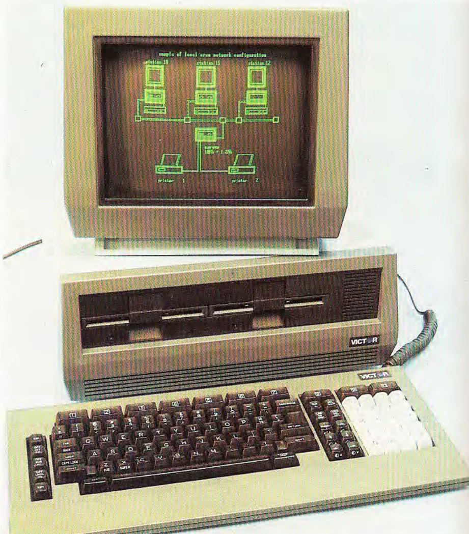
La versión CP/M 86 es empleada por ordenadores de 16 bits. Este ordenador incorpora el microprocesador 8088 y se gestiona mediante esta variante de CP/M.
