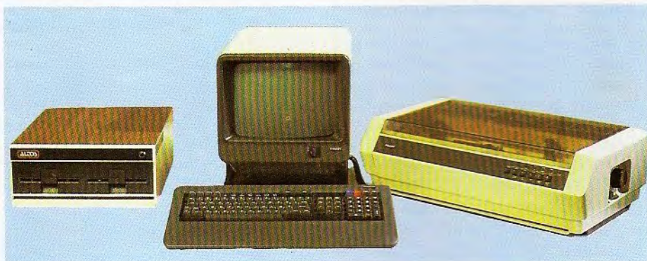
El sistema operativo MP/M es un sistema operativo compatible con el CP/M para microordenadores de 8 bits que operen en multitarea. La CPU del ordenador de la figura es un Z-80, lo que permite operar con este sistema operativo.
