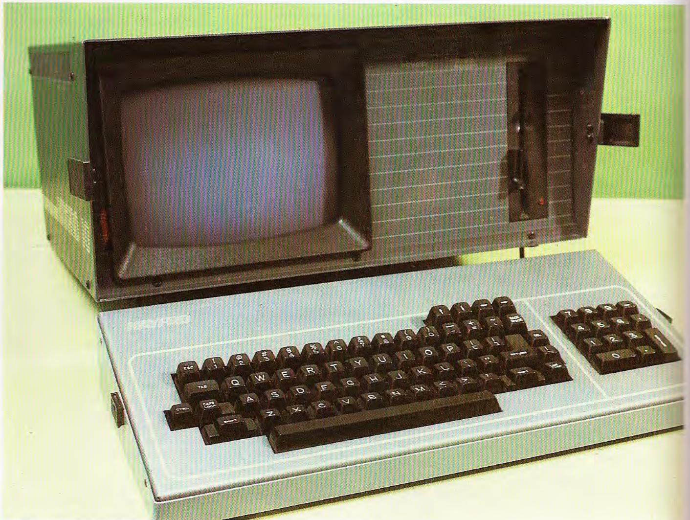
Muchos ordenadores portátiles basados en el microordenador Z-80 están regidos por el sistema operativo CP/M. El ordenador de la figura utiliza la variante CP/M 2.2.
