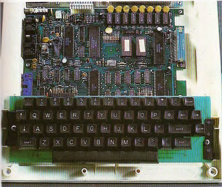
Circuitería electrónica constitutiva de la unidad central del ordenador doméstico Dragon-32. El elemento esencial es el microprocesador Motorola 6809.
