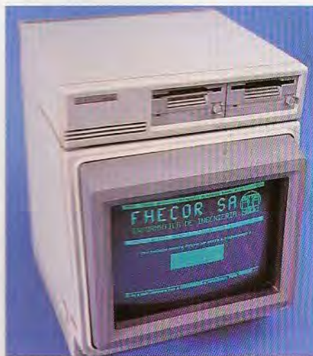
Una de las peculiaridades del Hewlett-Packard 150 II reside en el accesorio de pantalla táctil, el cual permite controlar las aplicaciones sin más que apoyar el dedo sobre la zona adecuada de la pantalla.
