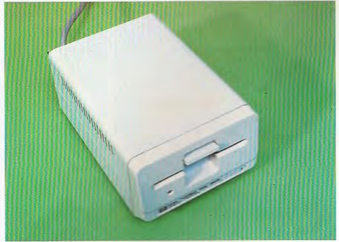
La mayor parte de los microordenadores recurren a unidades de disco flexible de 5 y 1/4 ó de 3,5 pulgadas como memorias de masa.
