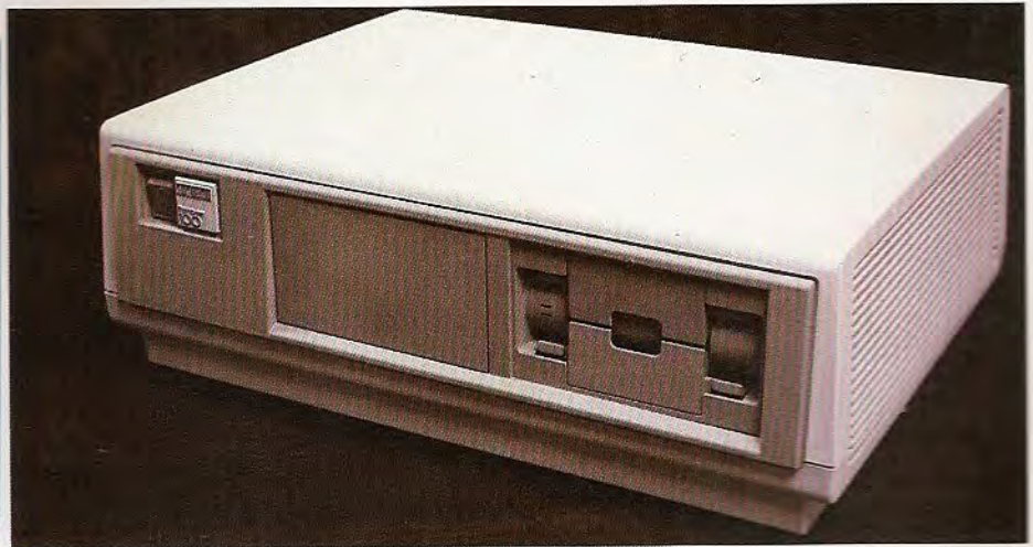
Unidad central de un microordenador para aplicaciones de gestión. En la zona derecha se observa la incorporación de una unidad de memoria de masa, concretamente un lector/grabador de discos flexibles.
