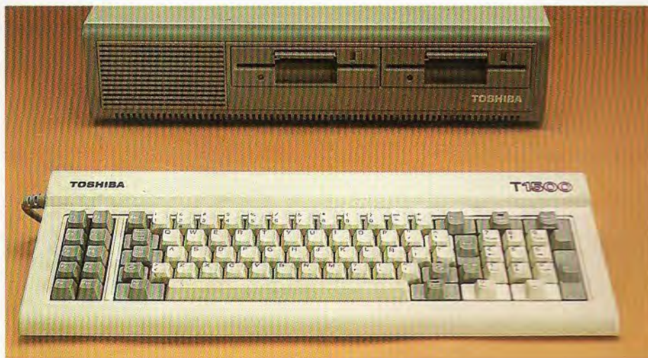
Unidad central —con doble unidad de disco flexible integrada— y teclado del ordenador personal Toshiba T1500, compatible IBM-PC.
