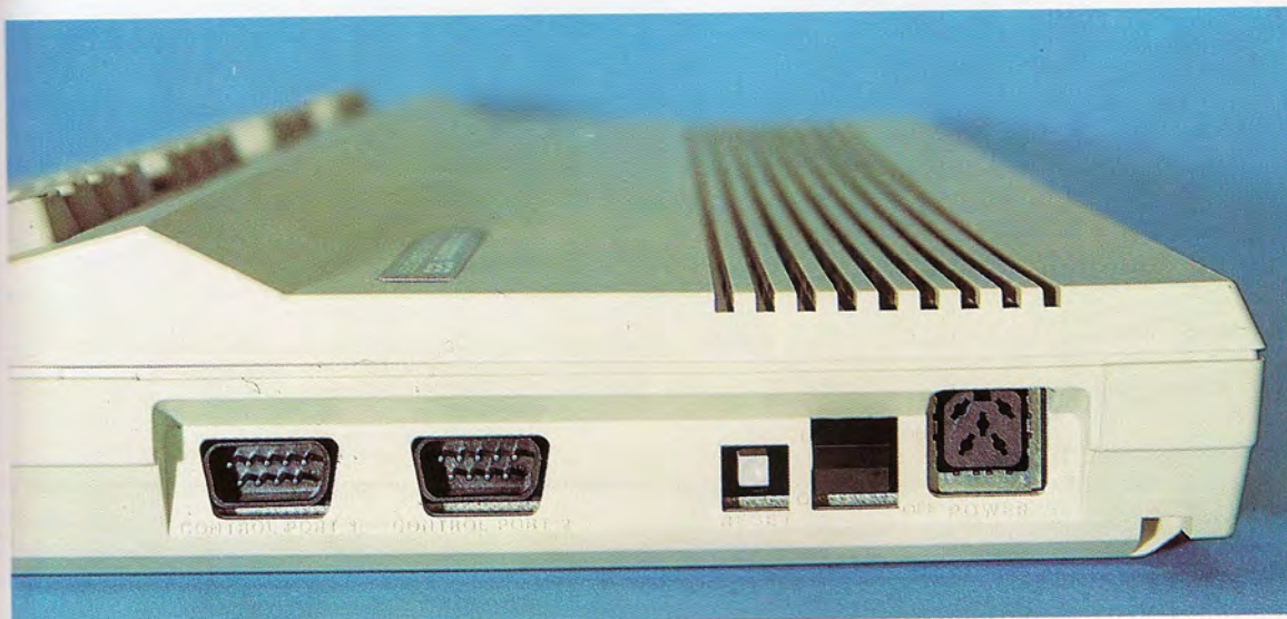
El C-128 dispone de conexiones específicas para TV y para dos tipos de monitores. Esta posibilidad potencia sus capacidades de representación gráfica
