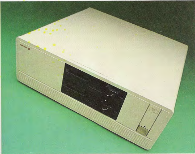
En la fotografía aparece la unidad central de una de las posibles configuraciones del Ericsson PC, equipada con dos unidades de disco flexible de 5 y 1/4" y 360 Kbytes por disco.
