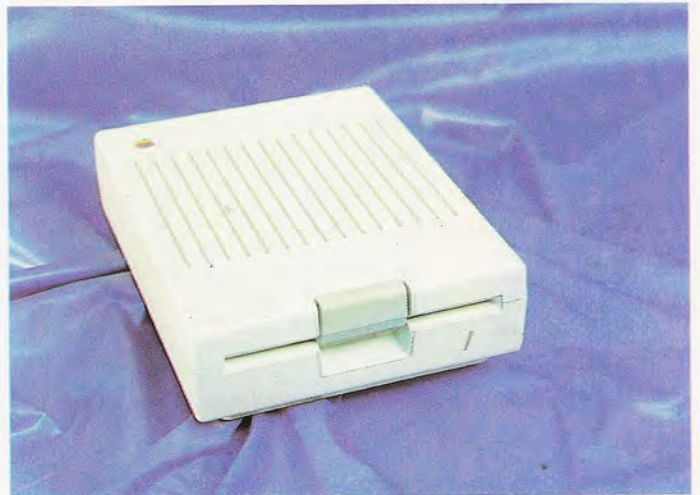
Unidad de disco flexible externa de 5 y 1/4", diseñada para el Apple IIc.
