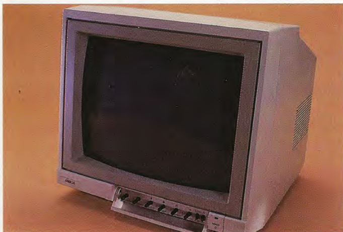
La máxima resolución gráfica del equipo, 640 x 400 pixels, admite el empleo de una paleta de 16 colores seleccionados entre la gama total de 4.096.
