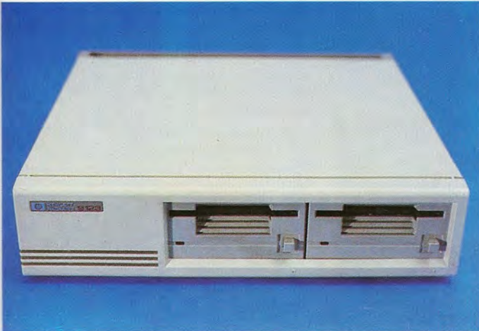
En la configuración estándar de base, el HP 150 II viene equipado con dos unidades de disco de 3,5" y 710 Kbytes por disco formateado.
