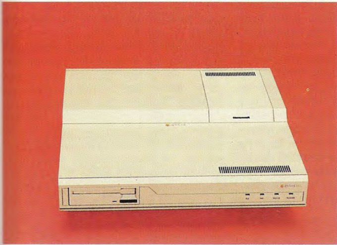
Bajo la trampilla que aparece en la zona superior derecha del mueble se encuentra el espacio reservado para los seis conectores de expansión —cuatro de ellos a disposición del usuario— que residen en la unidad central.
