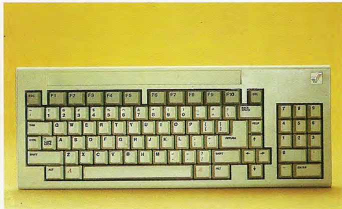
El teclado del Amiga es independiente, escamoteable bajo el mueble de la unidad central y provisto de 89 teclas.
