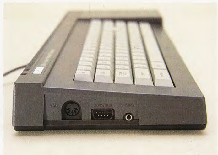
Disposición de conectores en la zona izquierda del mueble que acoge al CPC-6128.
