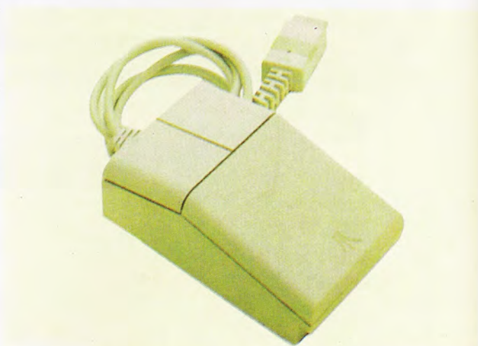
El ratón incorporado a la versión base del equipo es de dos botones y dotado de sensores de alta precisión para traducir las rotaciones de la bola antideslizante.
