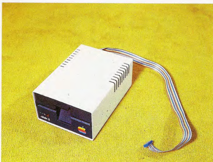
A través de las apropiadas tarjetas de control, el equipo puede gestionar varias unidades de disco externas.
