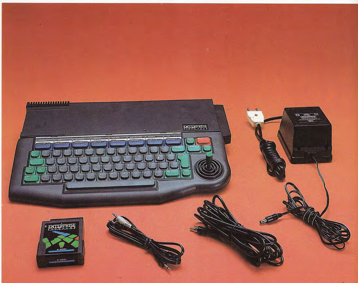
El equipo se suministra junto con la fuente de alimentación, los cables para su conexión al magnetófono a cassetes y al receptor de TV color, los respectivos manuales y, por supuesto, el cartucho ROM en el que reside el intérprete BASIC.
