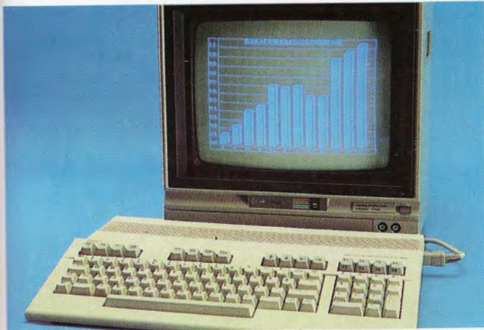
El C-128 dispone de conexiones específicas para TV y para dos tipos de monitores. Esta posibilidad potencia sus capacidades de representación gráfica
