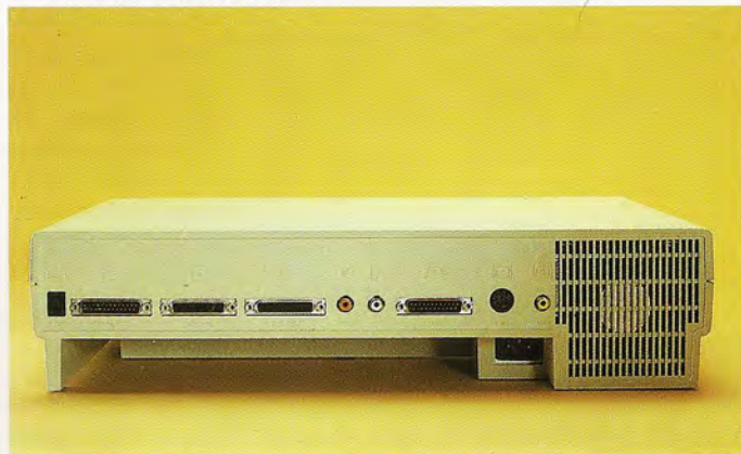
El panel posterior ofrece, además de las salidas para audio y vídeo, una toma con interface serie RS/232C, otra de tipo paralelo Centronics y un conector para unidad de disco externa.
