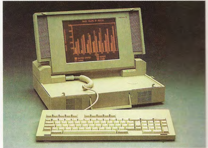
En el Ericsson Portable se ha optado por aplicar los últimos avances en tecnología de visualización sobre pantalla de plasma gaseoso.
