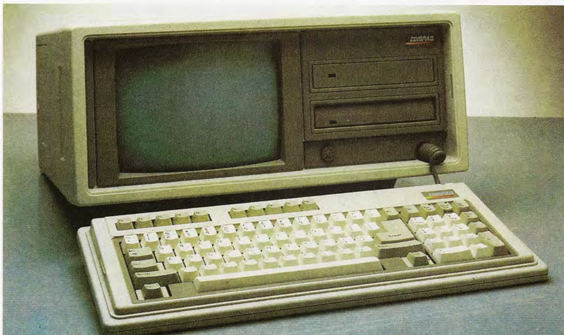
Fotografía del modelo Compaq Portable II/3, equipado con 640 Kbytes de RAM, una unidad de disco flexible de 360 Kbytes y un disco rígido de 10 Mbytes.
