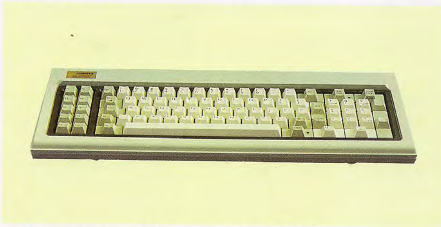
El teclado que acompaña a los modelos Compaq Deskpro es el tipo QWERTY y análogo al que equipa a los ordenadores IBM-PC.
