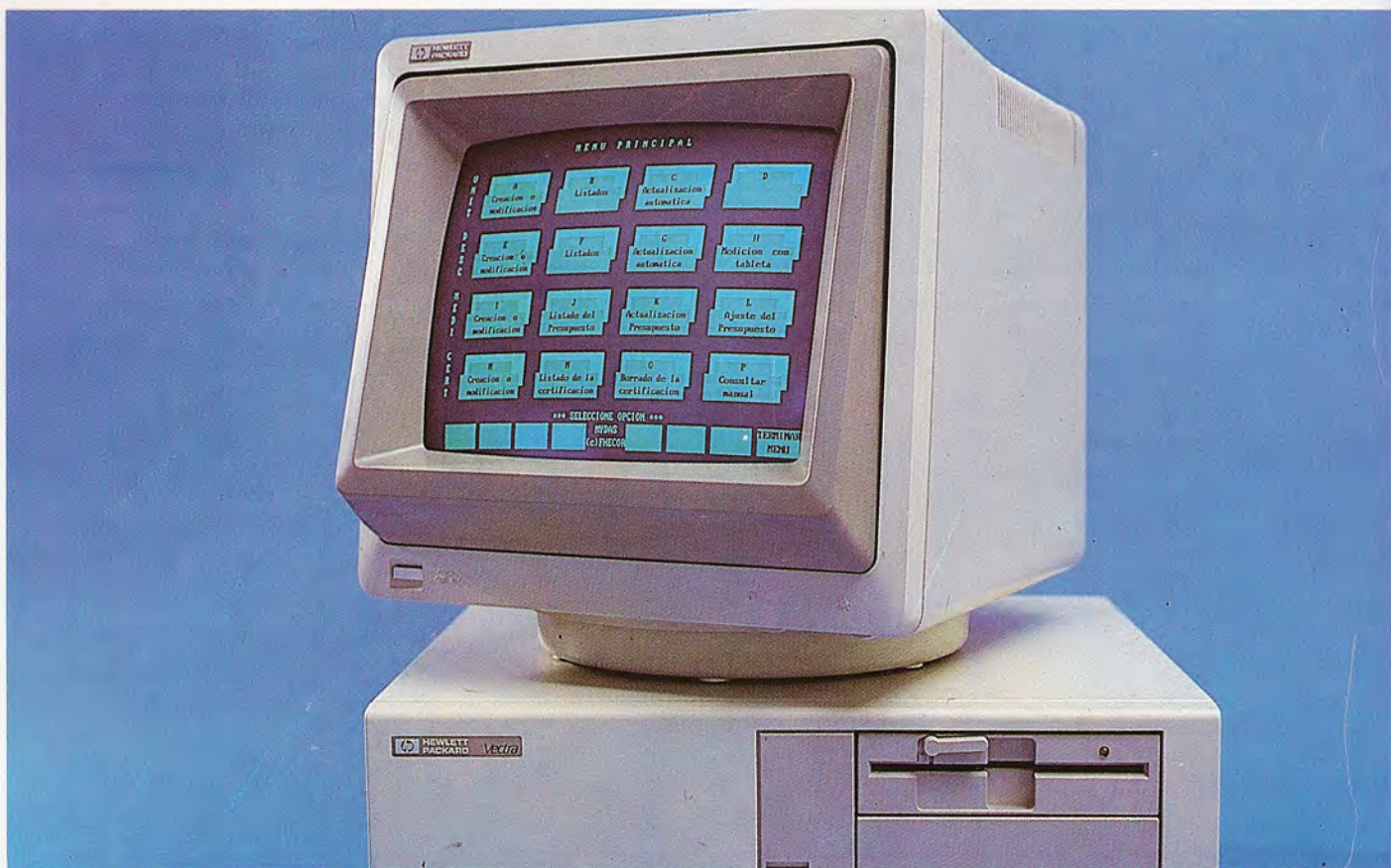
La explotación del HP Vectra-PC está gestionada por el sistema operativo MS-DOS 2.11, con la interposición del «Gestor de Aplicaciones Personales» PAM.
