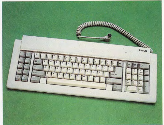
El teclado que acompaña a las diversas configuraciones de la gama Epson PC ofrece una distribución de teclas análoga a la del teclado IBM-PC.
