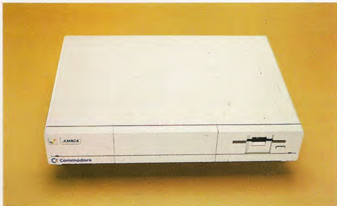
Unida central del Amiga, en la que está integrada la unidad de disco de 3,5".
