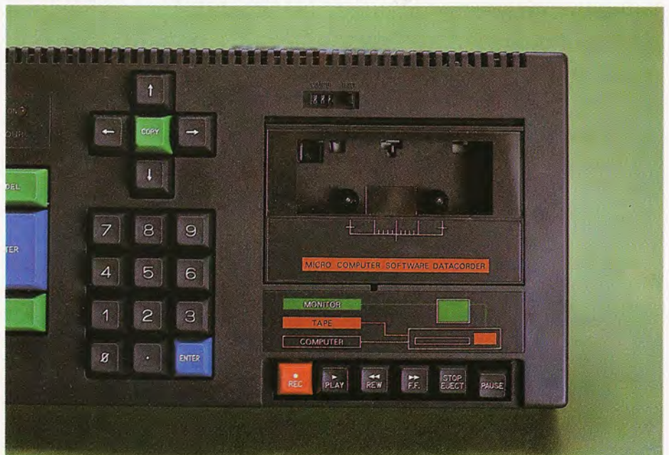
Unidad de casete incorporada en el equipo. Con ella es posible la grabación en formato protegido de los programas escritos en Locomotive BASIC.
