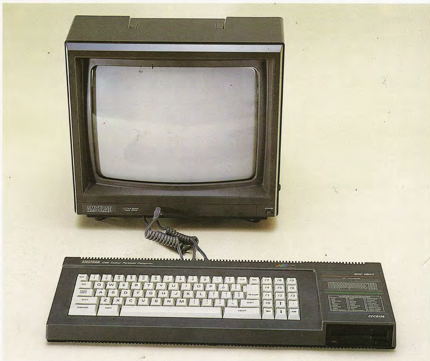
El sistema informático Amstrad CPC-6128. Un ordenador de «una pieza», con 128 K de RAM y 48 K de ROM. Lleva una unidad de disco de 3" incorporada y es capaz de trabajar con tres sistemas operativos distintos: AMSDOS, CP/M 2.2 y CP/M 3.0.
