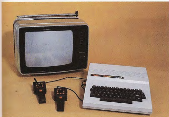
Una alternativa barata y usual en los equipos de su categoría es la utilización de un receptor de TV convencional como periférico de visualización.
