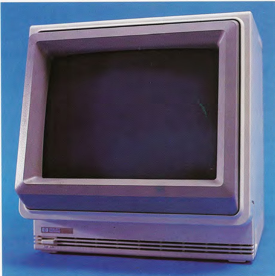
Una de las peculiaridades del HP 150 II es el accesorio de pantalla táctil. Este permite controlar el desarrollo de las aplicaciones sin más que apoyar el dedo sobre la pantalla.
