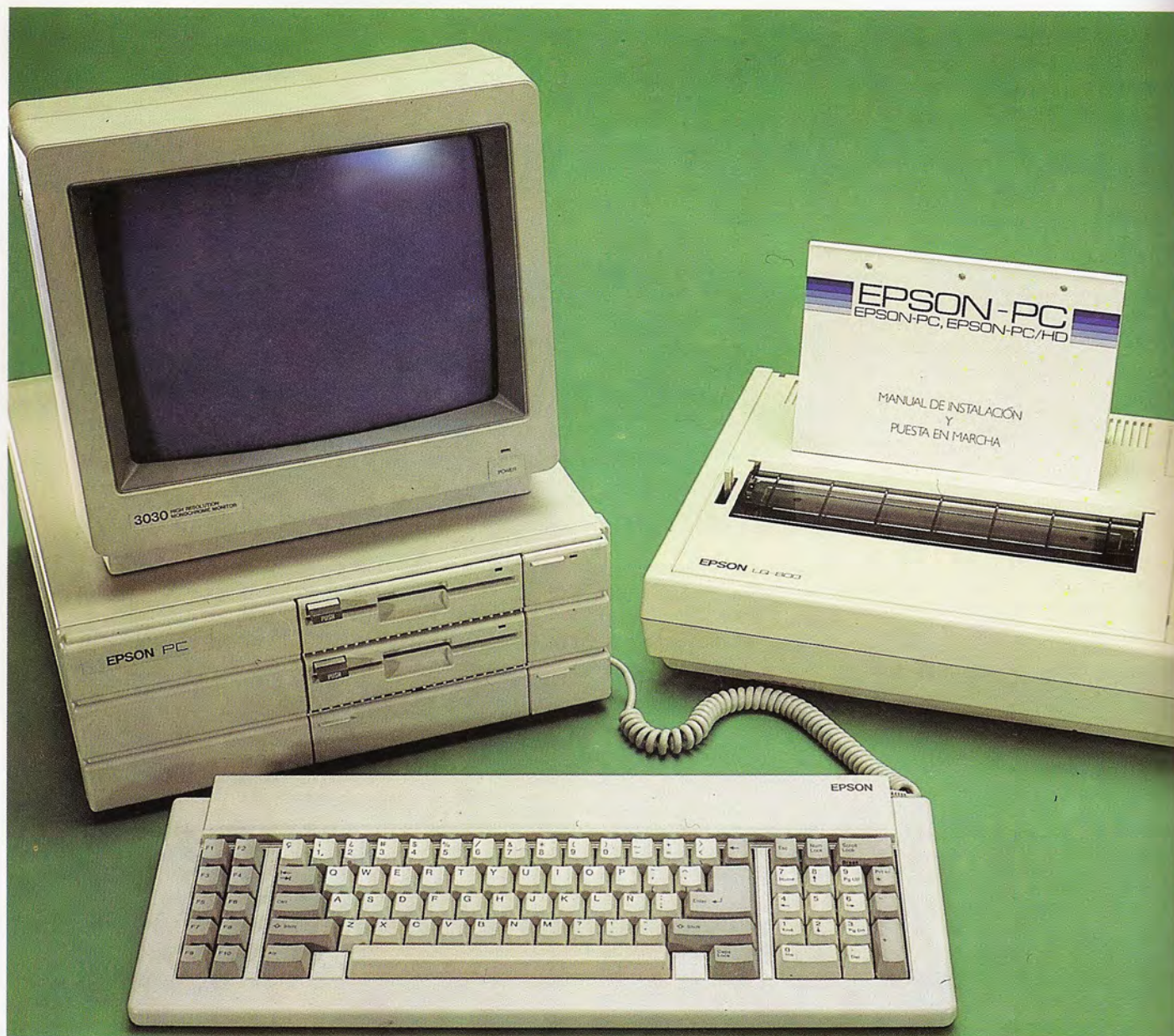
Configuración de un Epson PC con doble unidad de disco flexible de 360 Kbytes, pantalla monocroma e impresora matricial de calidad carta.
