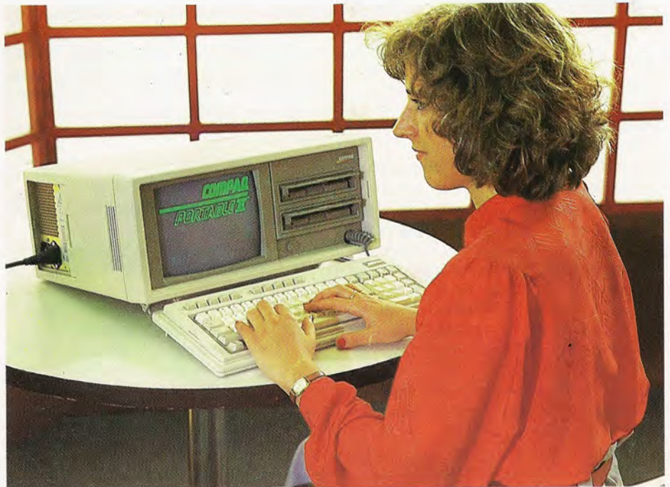
El ordenador incorpora una pantalla monocroma de fósforo verde con una diagonal de 9 pulgadas y capacidad de operación en modo dual.
