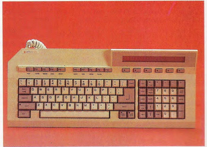
Un teclado elegante, ergonómico, con un total de 102 teclas y equipado con una micropantalla de cristal líquido que puede visualizar hasta dos líneas de cuarenta caracteres.
