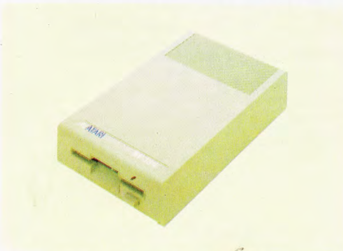
El Atari 520 ST admite dos unidades de disco de 3,5" de simple o doble cara, con capacidades respectivas de 360 ó 720 Kbytes por disco formateado.
