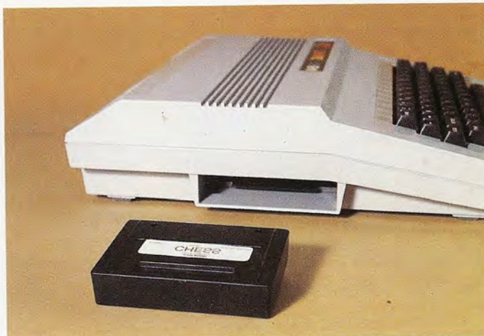
Una visión lateral del Dragon revela la posición del conector para enchufar los cartuchos ROM.
