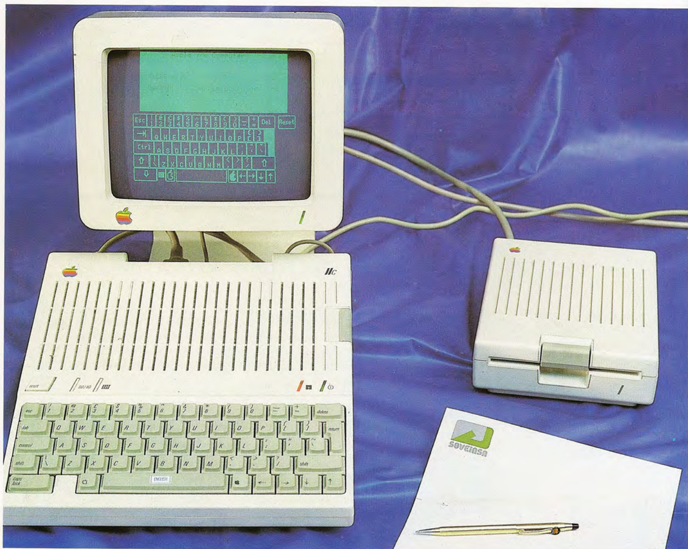
El Apple IIc en una configuración equipada con unidad de disco externa y pantalla de fósforo verde.
