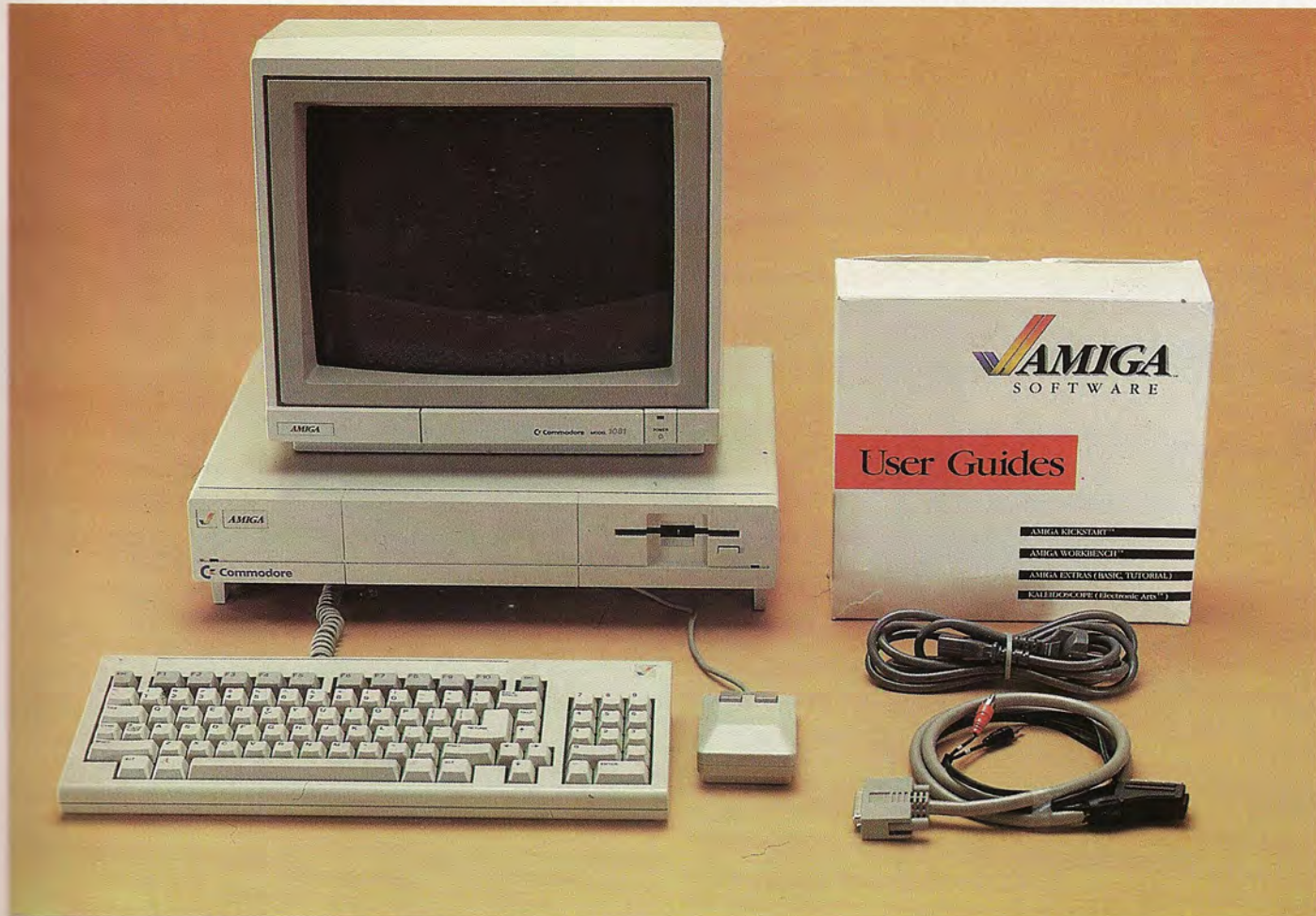
La configuración básica del Commodore Amiga incluye la unidad central —con un total de 768 Kbytes de RAM y 64 K de memoria ROM—, unidad de disco integrada de 3,5" y 880 Kbytes, monitor de color, teclado y ratón.
