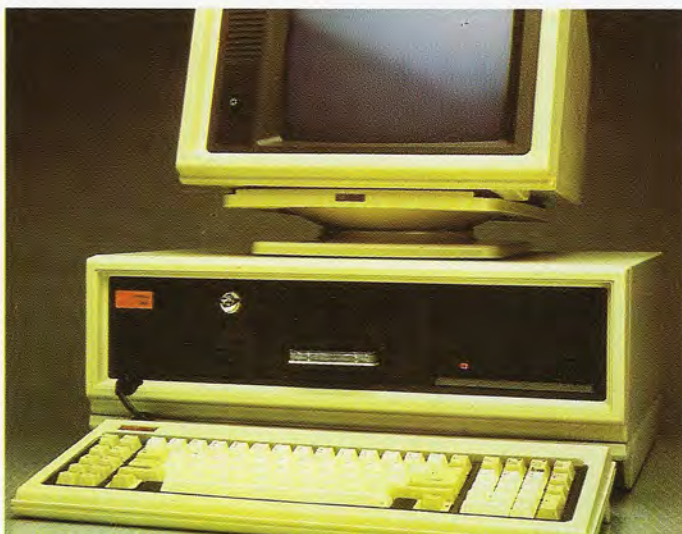
El mueble que acoge al Compaq Deskpro 286 admite la integración de hasta cuatro unidades de almacenamiento masivo: discos flexibles, discos rígidos y unidades de cinta magnética para «back-up».
