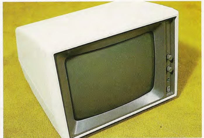
El monitor de vídeo de la versión básica es de tipo monocromático. El formato de presentación en pantalla es de 21 filas por 40 columnas, ampliables a 80 columnas mediante una tarjeta de expansión.
