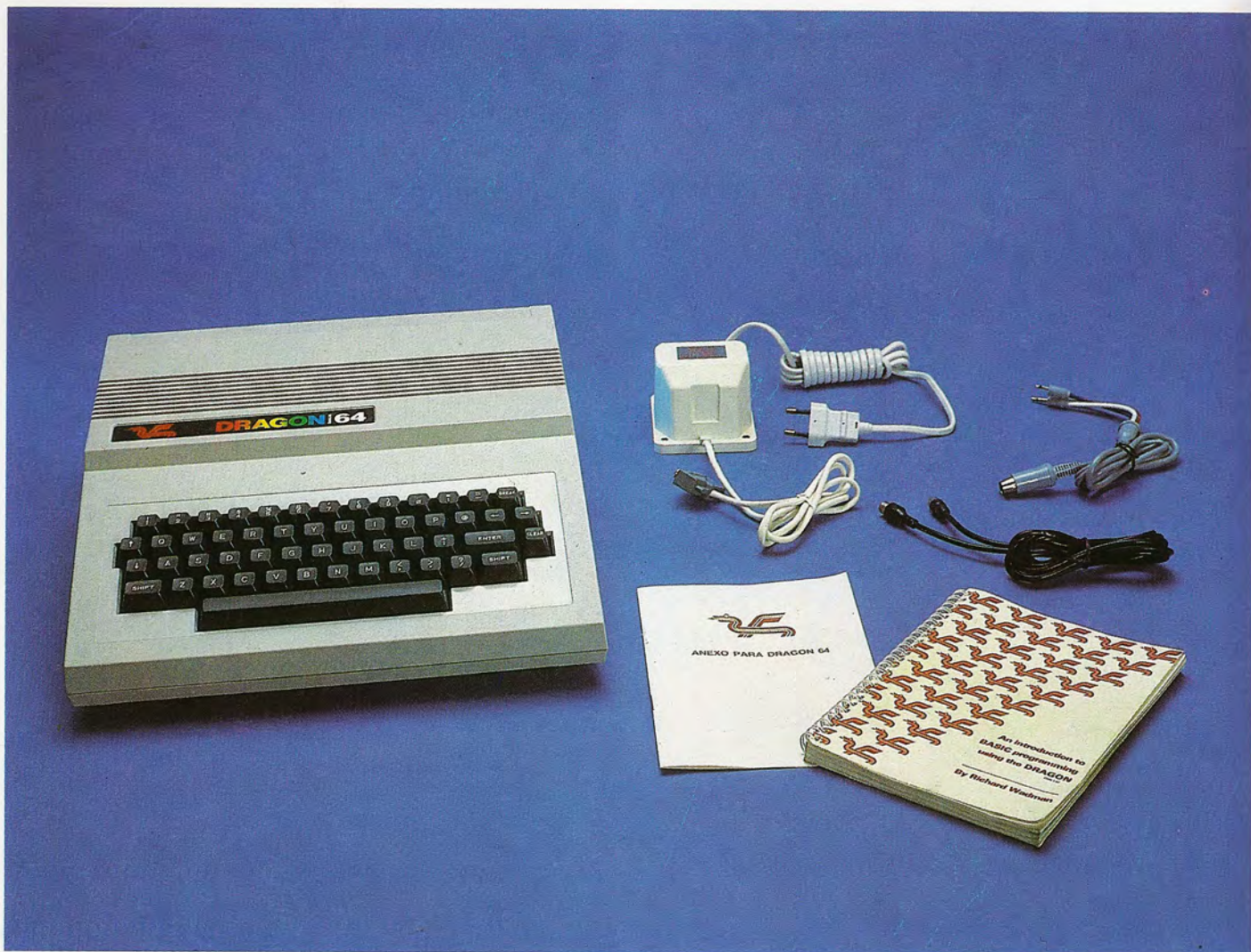
Equipo básico entregado con el Dragon 64: unidad central, fuente de alimentación, cables para TV y casete, y manuales.
