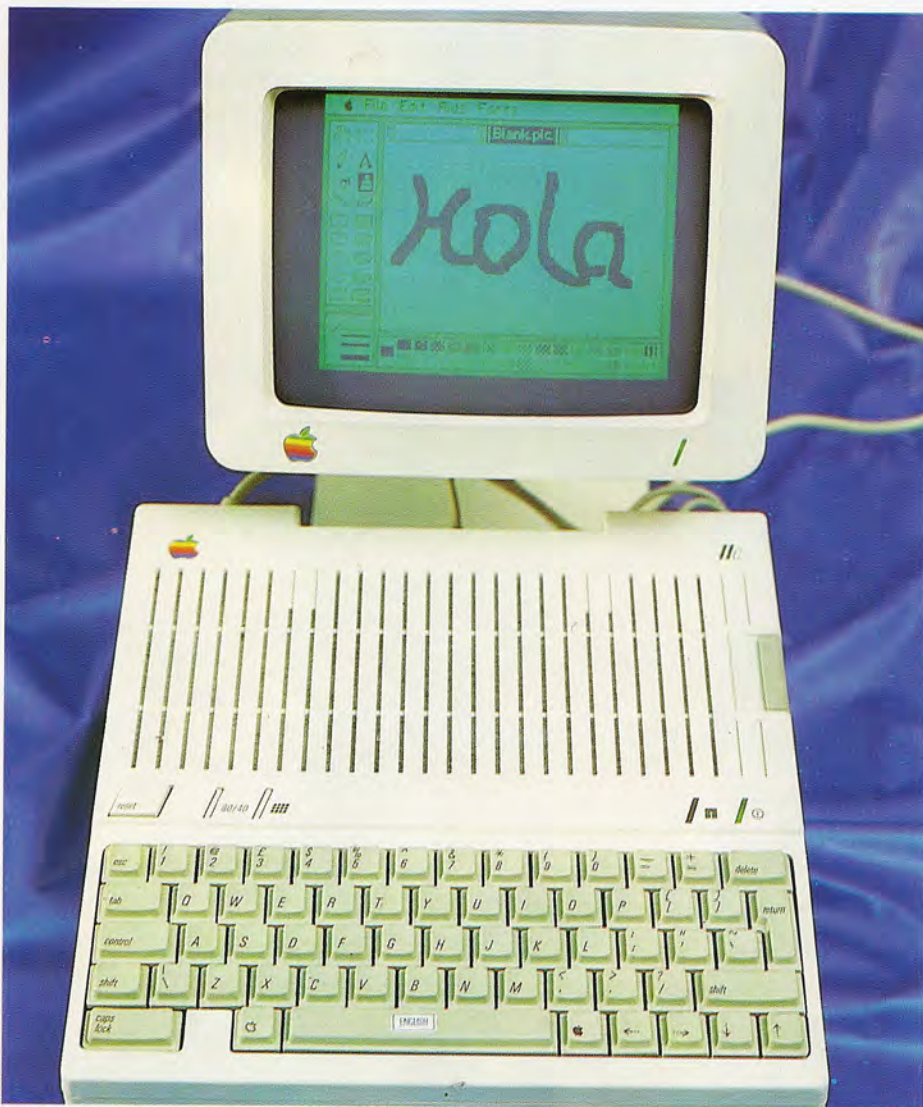
Configuración básica del Apple IIc: unidad central con lector de disco flexible incorporado y monitor de visualización.
