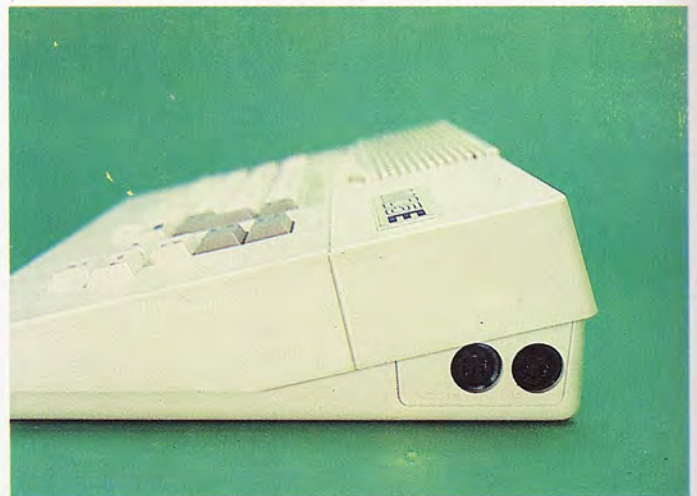
En el lateral derecho del mueble se encuentran dos tomas DIN para la conexión de la unidad de casete y el lápiz óptico.
