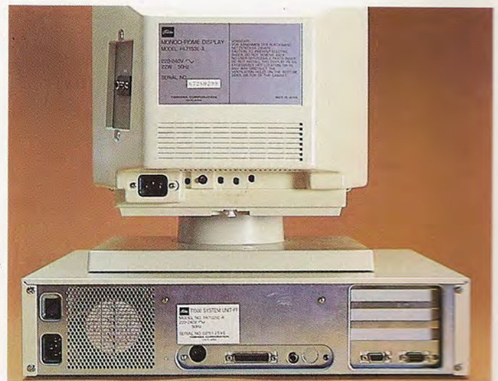
En el panel posterior del mueble, se observan las tres ranuras destinadas al acceso al exterior de los conectores que, eventualmente, pueden partir de las tres tarjetas de expansión conectables al Toshiba T 1500.
