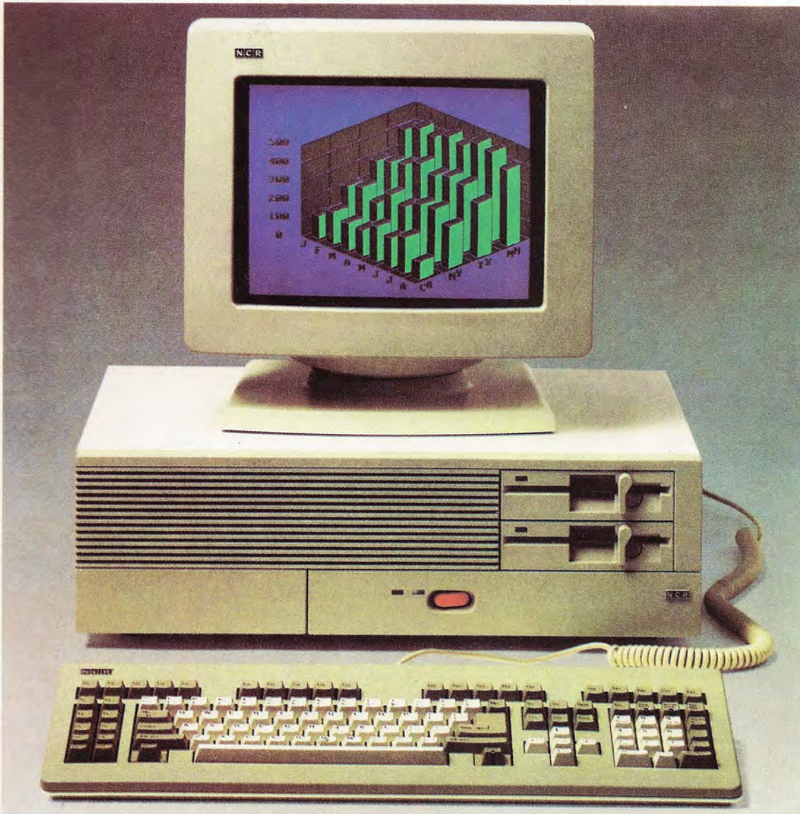
El NCR PC8 es un ordenador personal basado en el microprocesador de 16 bits Intel 80286 y compatible con el PC/AT de IBM.
