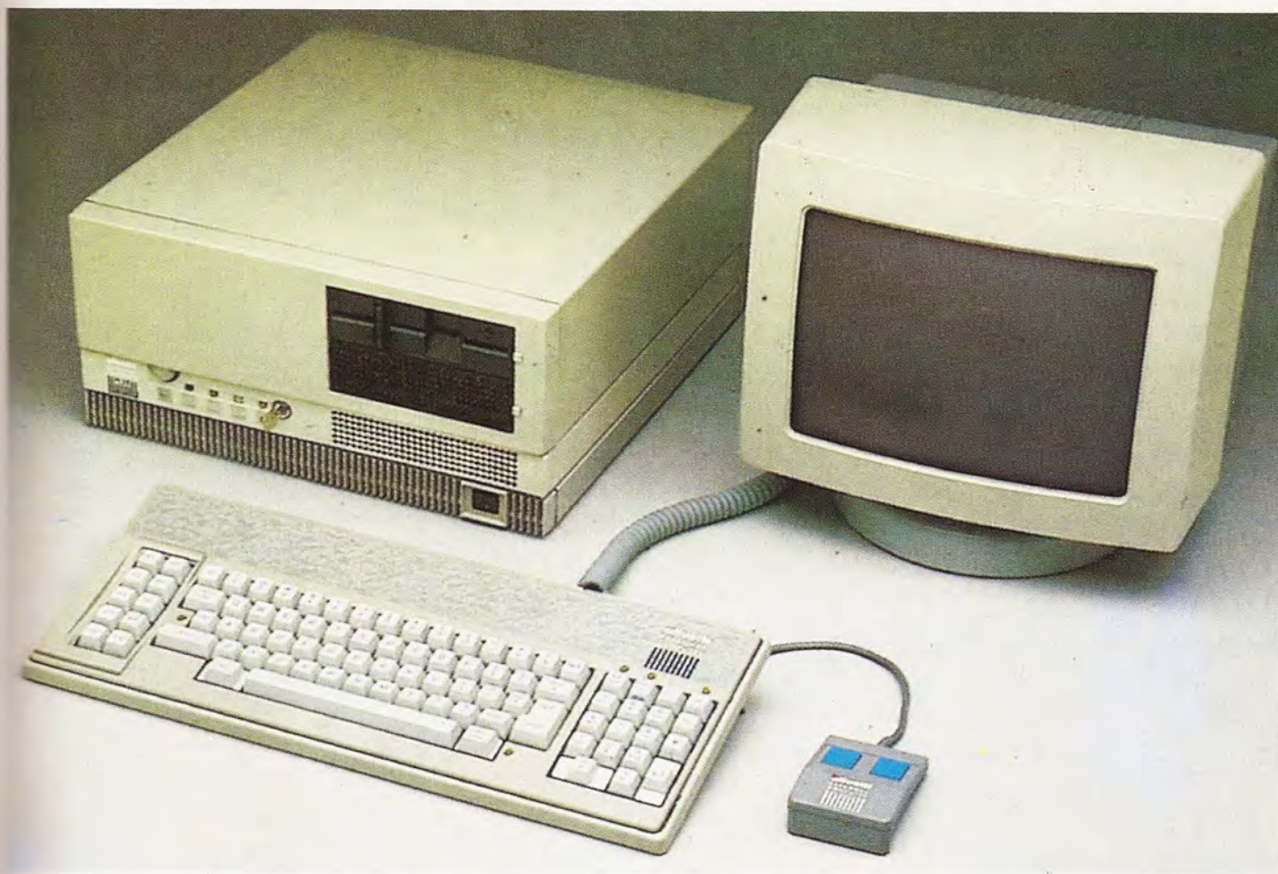
La evolucionada arquitectura del M-28 y su acusada modularidad brindan al usuario amplias posibilidades de expansión. El equipo puede llegar hasta los 7 Mbytes de memoria RAM, hasta 70 Mbytes en disco y 60 Mbytes en cinta magnética.
