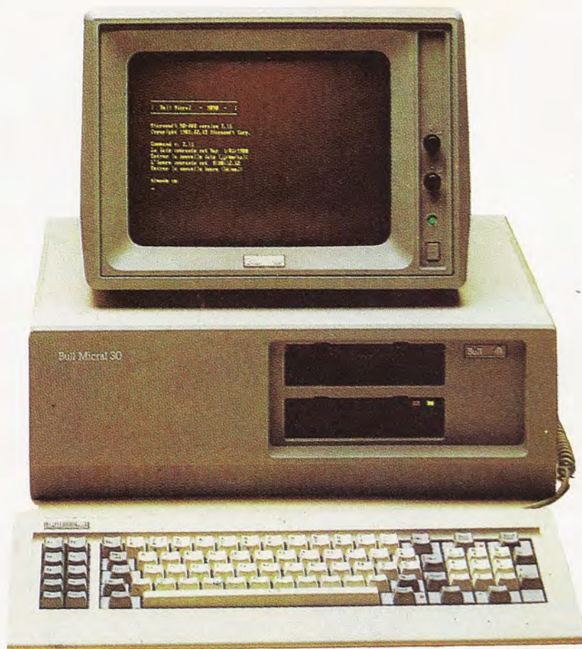
El Micral 30 es un ordenador personal compatible con la línea trazada por el PC de IBM y fabricado por la firma francesa Bull.
