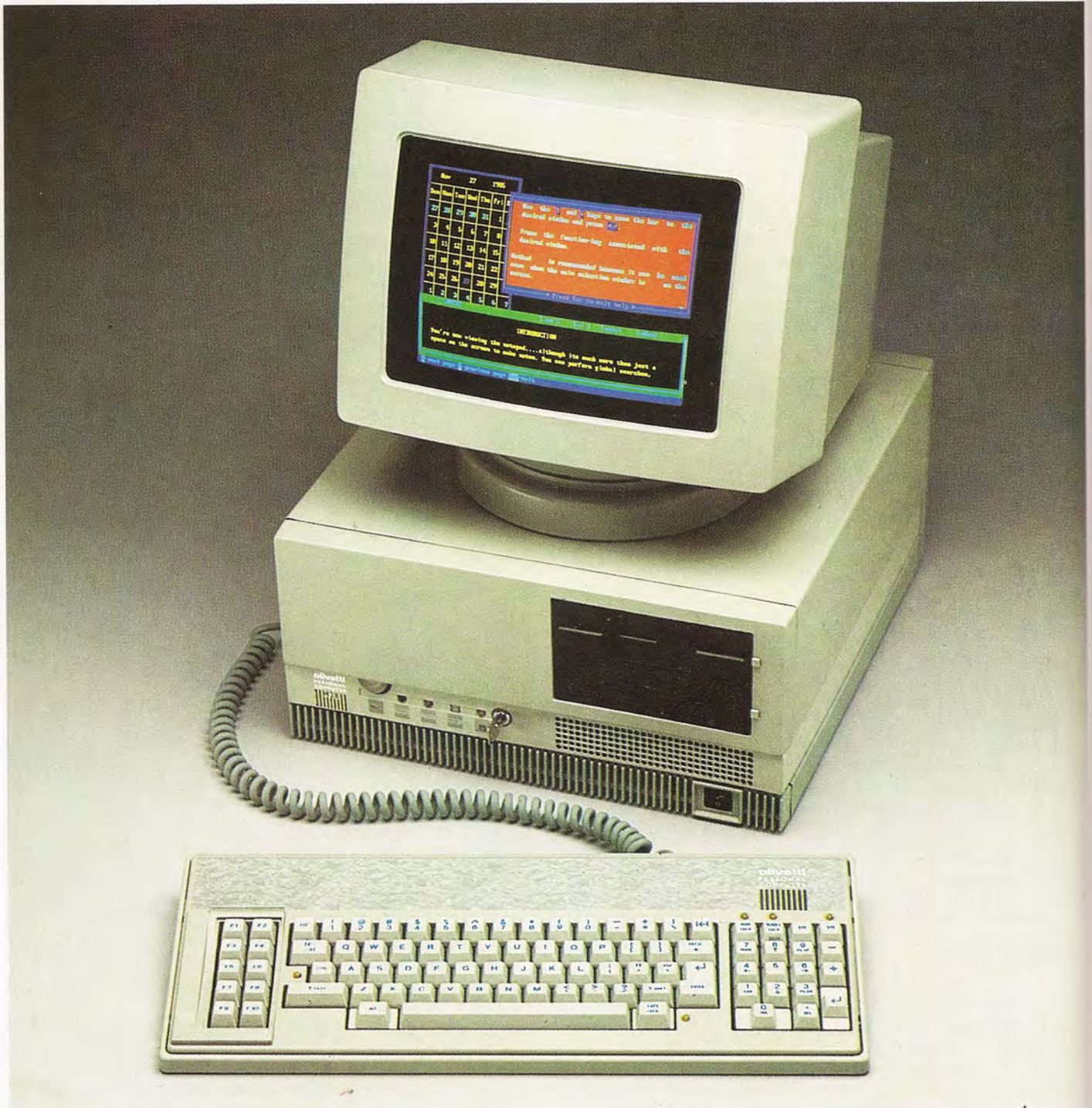
La compatibilidad IBM-PC/AT dentro de la familia de ordenadores personales de Olivetti toma cuerpo en el modelo M-28, equipado con el microprocesador Intel 80286 a 8 MHz.
