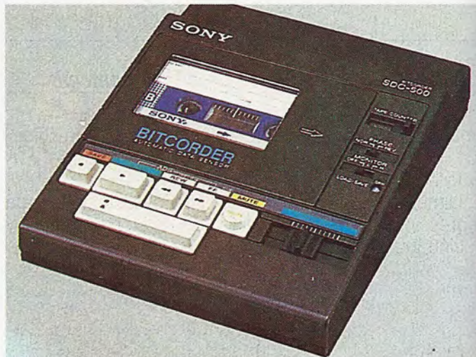
Unidad para lectura/escritura de datos en casetes estándar de audio diseñada por Sony para la familia de ordenadores domésticos MSX.
