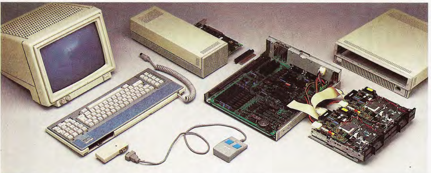
El Olivetti M-19 está basado en el microprocesador Intel 8088 operando a la frecuencia de reloj de 4,77 MHz. Opcionalmente puede trabajar a 8 MHz con la ayuda de una expansión denominada «kit de doble velocidad».
