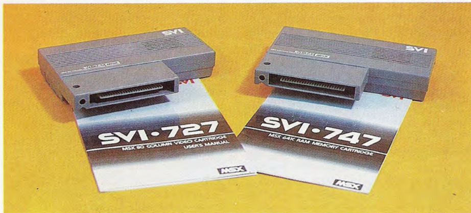
Dos representantes de la familia de expansiones MSX de la firma Spectravideo: el SVI-727 (cartucho para la presentación de texto en 80 columnas) y el SVI-747 (expansión de memoria RAM de 64 Kbytes).
