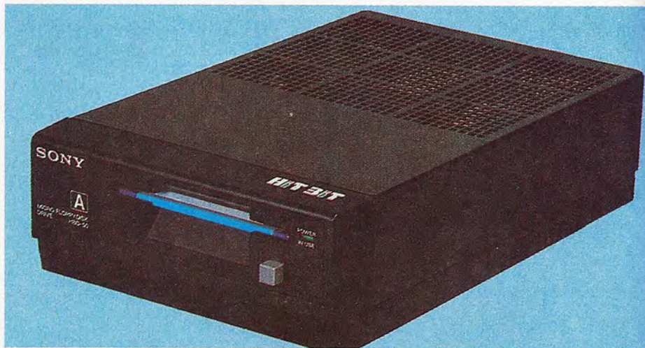
Unidad de disco flexible Sony HBD-50. Utiliza discos flexibles de 3,5 pulgadas y es conectable a cualquier ordenador ajustado al estándar MSX.
