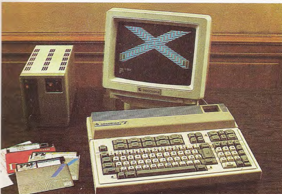
Configuración integrada por la unidad central FM-7, monitor de color y unidad para discos flexibles de 5 y 1/4 pulgadas.
