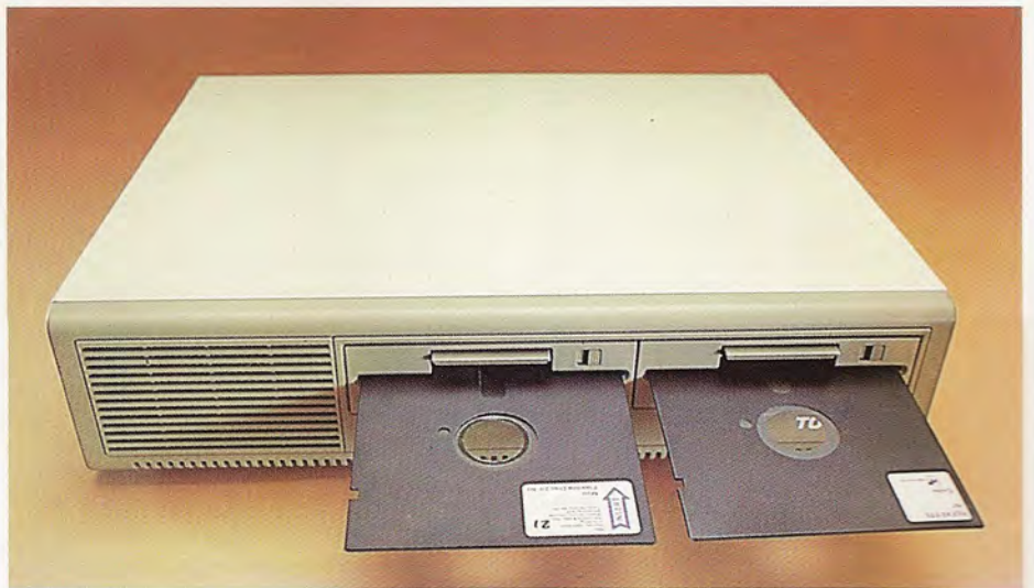
Una de las configuraciones en las que se suministra el T 1500 es la denominada FF, equipada con dos unidades de disco flexible de 5 y 1/4 pulgadas y 360 Kbytes por disco formateado.
