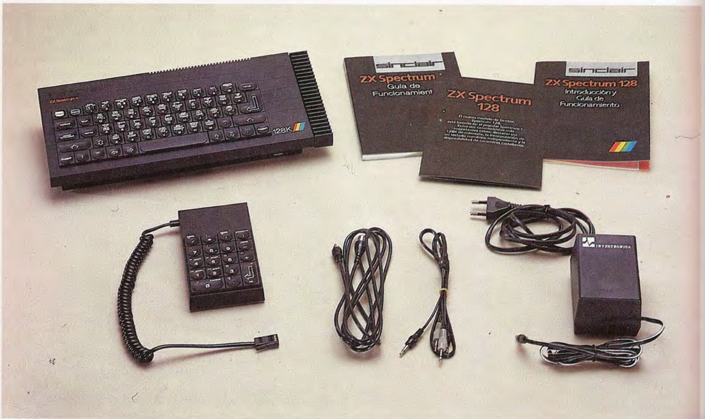
El sistema al completo: unidad central Spectrum 128 K, keypad numérico y de control del cursor, fuente de alimentación, cables para TV y unidad de casete y documentación.
