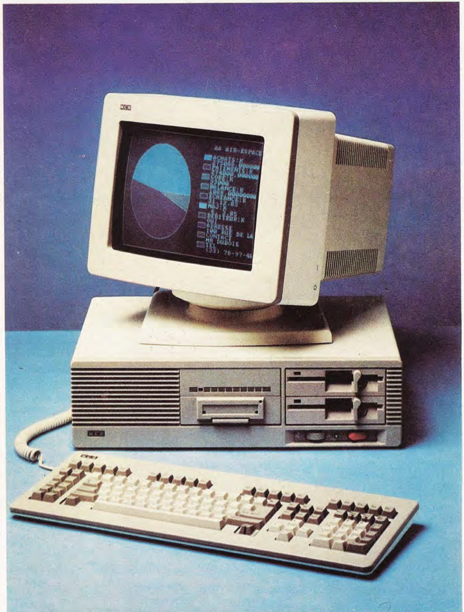
El mueble del NCR PC6 admite la integración de hasta cuatro subsistemas de almacenamiento masivo: unidades para discos flexibles, discos rígidos o unidades para back-up en cinta magnética.
