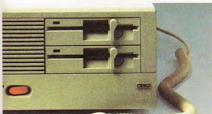
La alternativa esencial en cuanto a unidades de disco flexible la representan las unidades para disquetes de 5 y 1/4" y 1,2 Mbytes por disco formateado.
