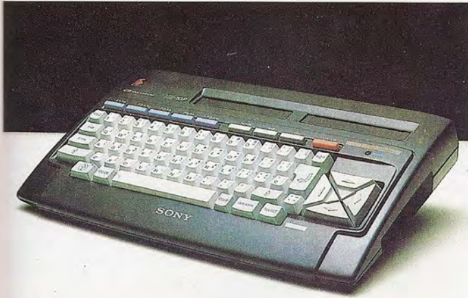
Ordenador doméstico Sony HB-10: una máquina ajustada al estándar MSX y equipada con un volumen total de 80 Kbytes de memoria RAM.
