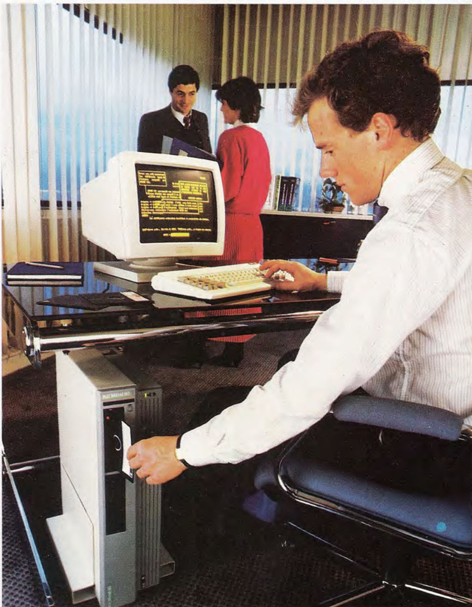
El Bull Micral 60 puede equiparse con un soporte diseñado para su utilización vertical, apoyándose en el suelo.
