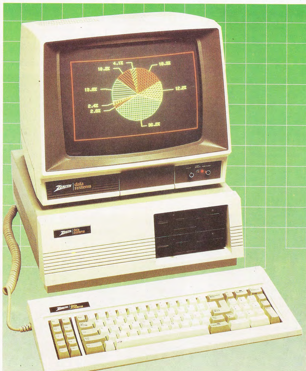
El Z-158 PC es un ordenador compacto y ligero, compatible IBM-PC/XT y con frecuencia de reloj seleccionable entre 4,77 y 8 MHz.
