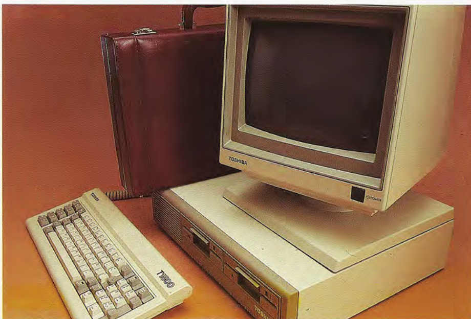
Configuración integrada por una unidad central Toshiba 1500 FF (doble unidad de disco flexible) teclado y monitor monócromo de fósforo verde.
