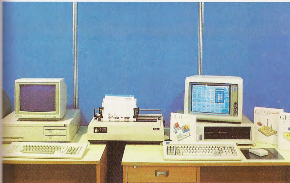
GEM Desktop, de Digital Research, es un buen ejemplo de entorno WIMP; con un amplio uso de recursos gráficos y capaz de hacer invisible al sistema operativo MS-DOS.
