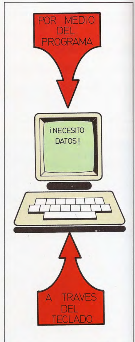
El cometido del ordenador es manipular datos de acuerdo a las indicaciones aportadas por el programa. Los datos pueden suministrarse a través de dos vías principales: el teclado, y formando parte del propio programa.
