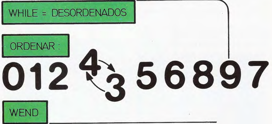
La instrucción WHILE hará que se repita una determinada acción mientras que sea cierta la condición impuesta.
