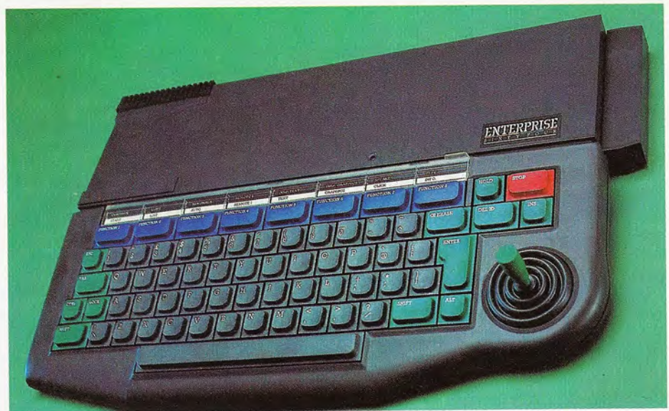
La presencia de teclas de función programables por el usuario es un detalle frecuente en los modernos microordenadores, tanto de tipo doméstico como profesional. En la fotografía se observan las ocho teclas de función (en color azul) del microordenador ENTERPRISE.
