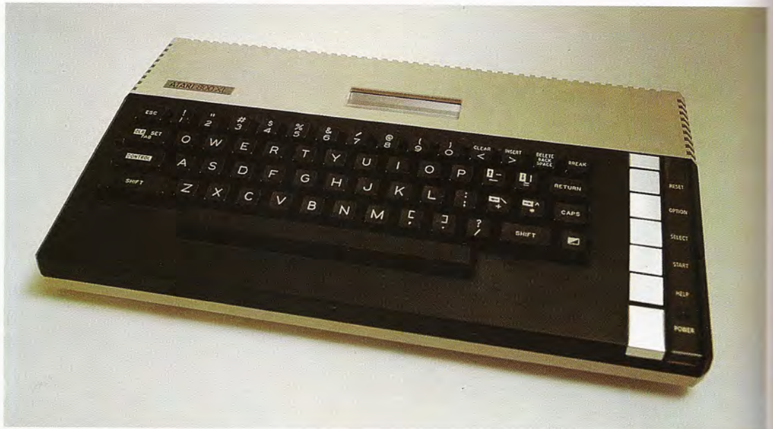
El ordenador doméstico Atari 800 XL incorpora dos tomas para joysticks provistos de conector estándar.
