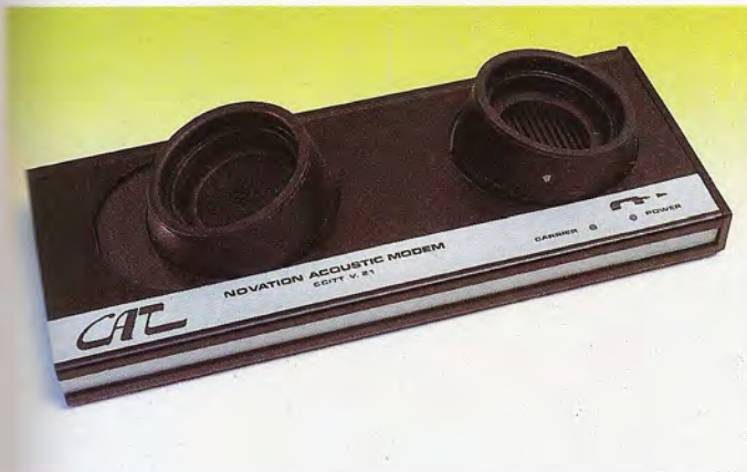
El CCITT CAT es un acoplador o periférico adecuado para la transmisión de datos a través de la línea telefónica.
