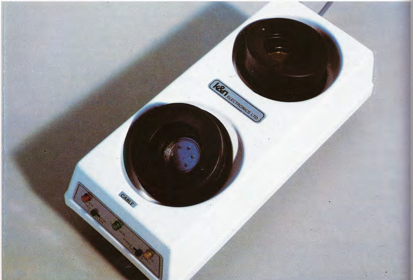
La serie KN-800 es una familia de modems provistos de acoplador acústico que consta de cuatro modelos, diferenciados por sus características de alimentación y modo de transmisión.
