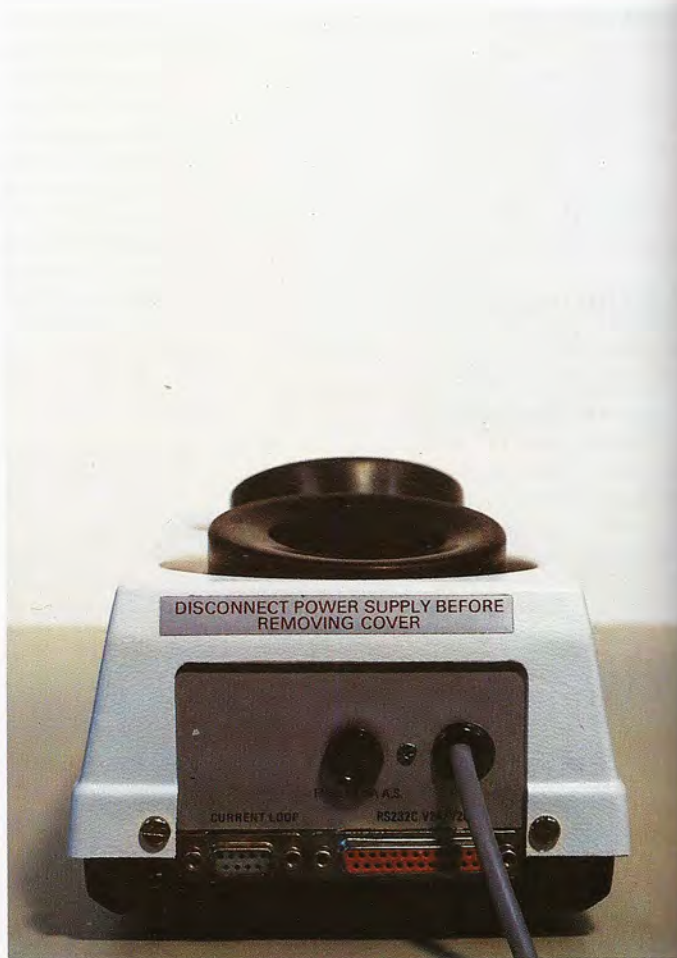
Los conectores para la comunicación exterior están situados en el panel posterior de la carcasa de material plástico. Los interfaces son el V24 (conector de 25 patillas) o el estándar «bucle de 20 mA» (conector de 9 patillas).
