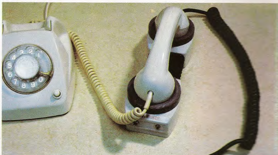
Modem dotado de acoplador acústico. El acoplador acústico permite la transmisión y recepción de datos a partir de un microteléfono convencional.
