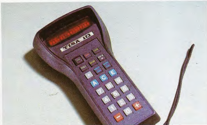
El terminal es un pequeño ordenador portátil alimentado por pilas. Este se conecta al ordenador central, a quien transmite los datos memorizados, a través de la línea telefónica.
