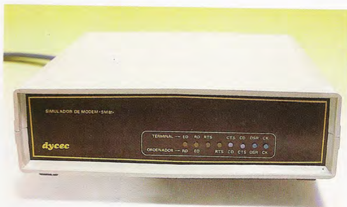
Los simuladores de modem realizan la emulación completa de una conexión con modems. El modelo SM-81 fabricado por DYCEC permite simular velocidades de transmisión, comprendidas entre 300 y 38.400 baudios.
