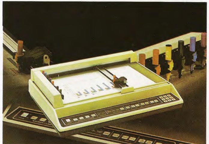
Una de las posibilidades más atractivas del modelo Complot DMP-40 es su posibilidad de actuar como digitalizador, bajo petición de panel frontal.
