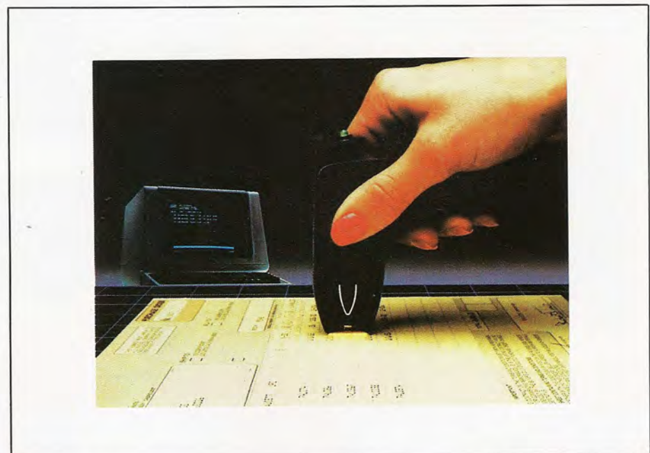
Lector de caracteres ortográficos de tipo «lápiz». El operador debe desplazar el periférico sobre el documento que quiere introducir.
