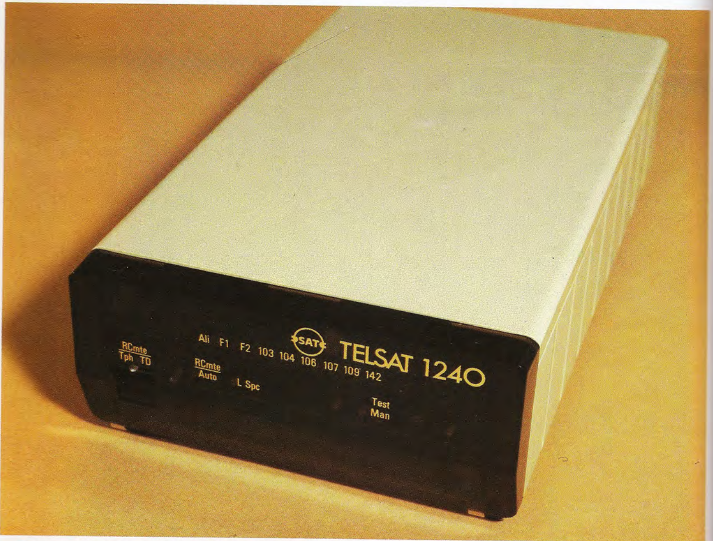
La gama de multiplexores SAT abarca velocidades de transmisión comprendidas entre 300 y 19.200 baudios. El modelo TELSAT 1240 tiene velocidad de transmisión seleccionable en 600 o 1.200 baudios, puede trabajar full-dúplex, y la comunicación se efectúa con la técnica FSK.
