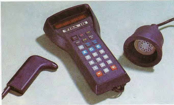
El Tisa 10 es un terminal portátil inteligente para la colecta y transmisión de datos a un ordenador central. Para realizar estas funciones dispone de un acoplador acústico telefónico y de un lector de código de barras independiente.
