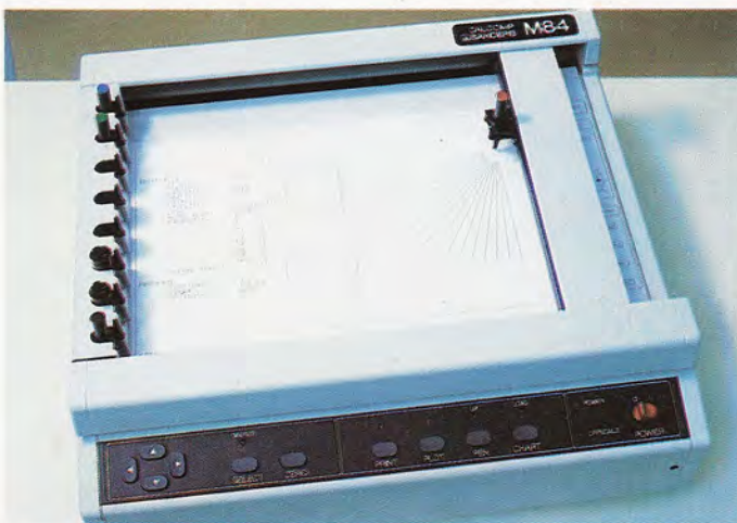
Plotter de mesa de tipo «beltbed». El modelo de la figura es el M84 de Calcomp: un trazador gráfico profesional orientado a la confección de gráficos y planos a color.
