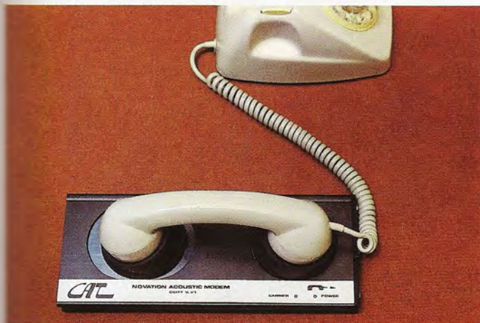
El acoplador dispone de dos copas de goma para su adaptación a un microteléfono de tipo convencional; esta medida da al equipo una relativa inmunidad respecto al ruido ambiente.
