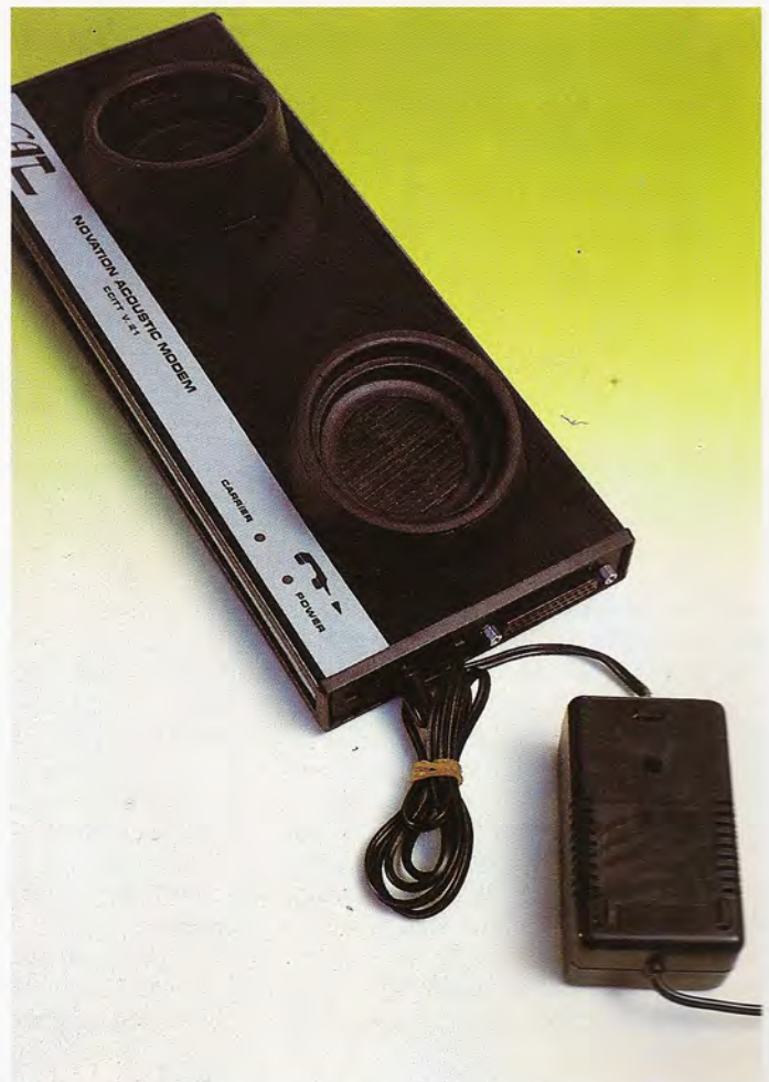
El dispositivo se alimenta a partir de la tensión de red, a través de la adecuada fuente de alimentación.
