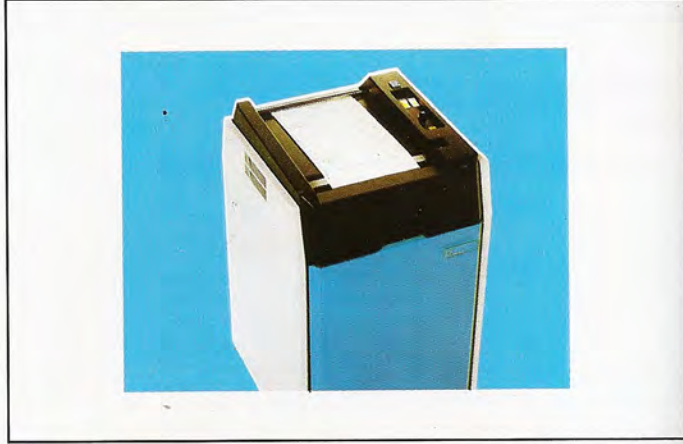
Los plotters electrostáticos proporcionan una alta velocidad de dibujo. Los modelos Benson de este tipo pueden utilizarse, además, como impresoras, ya que son capaces de generar caracteres alfabéticos.
