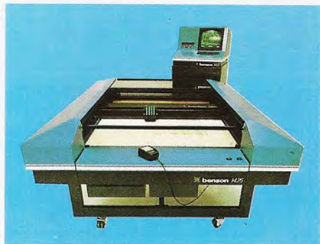
Plotter de mesa Benson 1425. EL papel se sujeta a la mesa de forma electrostática. Este modelo puede efectuar rotaciones del dibujo de 90, 180 ó 270 grados.
