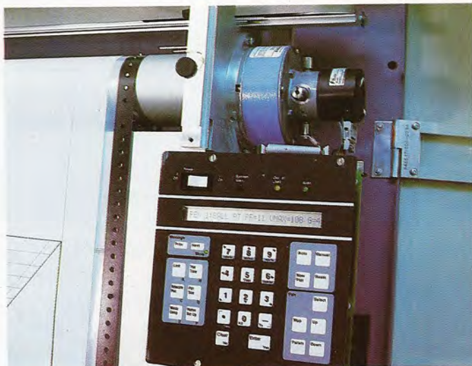
El teclado de control del modelo 965 permite la selección de diversas posibilidades de trabajo, como, por ejemplo, presión de las plumas, velocidad máxima, límites del dibujo...
