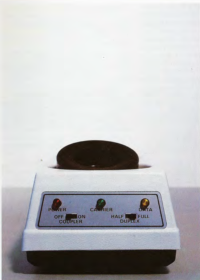
Panel frontal común a los acopladores acústicos de la serie KN-800. Posee dos conmutadores (conexión y selección half/full dúplex) y tres indicadores a LEDs.
