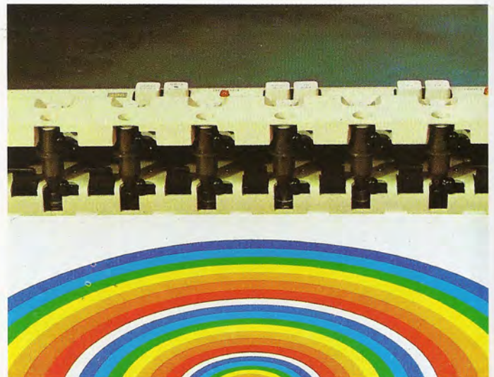
Plumas de impresión de plotters HP 7220. Sus ocho plumas admiten seis anchos distintos de línea.
