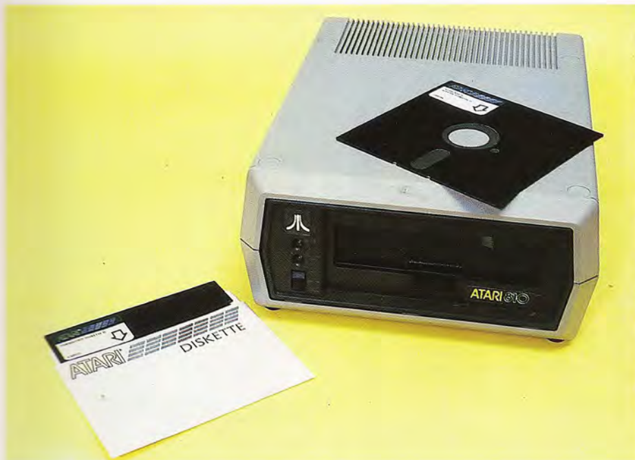
El sistema operativo ATARI.DOS II reside en un disco flexible de cinco pulgadas y cuarto. Este es ejecutable desde las unidades de disco ATARI-810 Disk Drive (reflejada en la fotografía), ATARI-815 Dual Disk Drive o en el modelo más reciente denominado ATARI-1050 Disk Drive.
