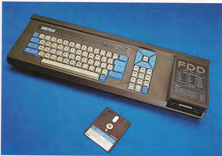
El modelo anterior al CPC 6128 de Amstrad, el CPC 664, no podía correr el sistema operativo CP/M Plus a no ser que le fuera conectada una ampliación de 64 Kbytes de memoria RAM.
