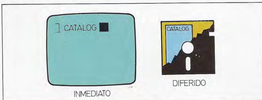
El modo de ejecución de los comandos puede ser inmediato o diferido, según éstos se introduzcan por el teclado o se encuentren dentro de un fichero.
