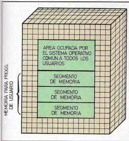
Distribución de la memoria central del ordenador al actuar bajo el control del sistema operativo MP/M.
