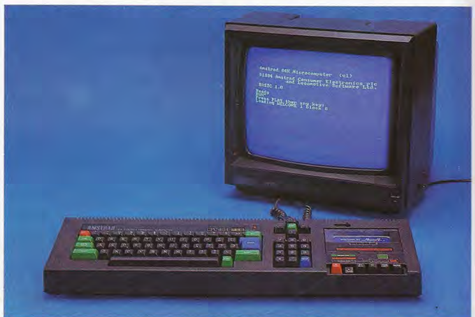
El CPC 464, el equipo inferior de la gama Amstrad, puede correr el sistema operativo CP/M 3.0 sin más que adquirir una unidad de discos y la correspondiente ampliación de memoria, que eleve al doble los 64 Kbytes estándar.
