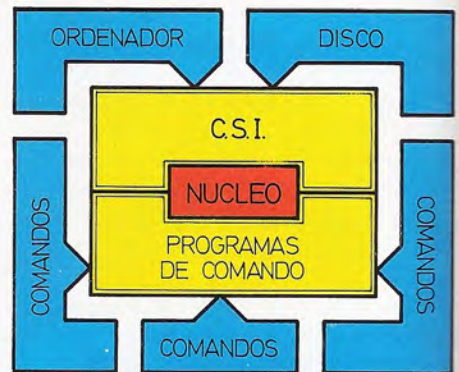
Estructura básica del sistema operativo OASIS.
