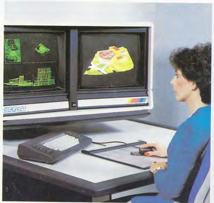
Las nuevas técnicas de diseño asistido por ordenador brindan, además de la posibilidad de crear gráficos y rotarlos según los tres ejes cartesianos, un efecto «zoom» que conserva la resolución gráfica.
