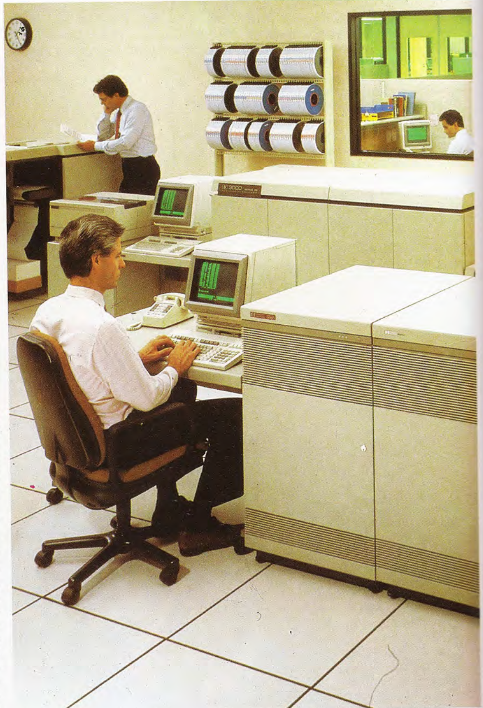
La serie 950, integrada en la familia de sistemas HP 3000, en uno de los dos primeros productos RISC de Hewlett-Packard que han llegado al mercado.
