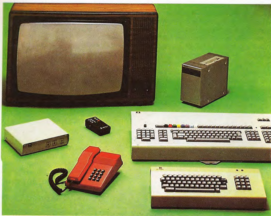
La conexión entre los terminales de usuario y los suministradores de información se realiza a través de las redes telefónicas (RTC) y públicas de transmisión de datos (IBERPAC).
