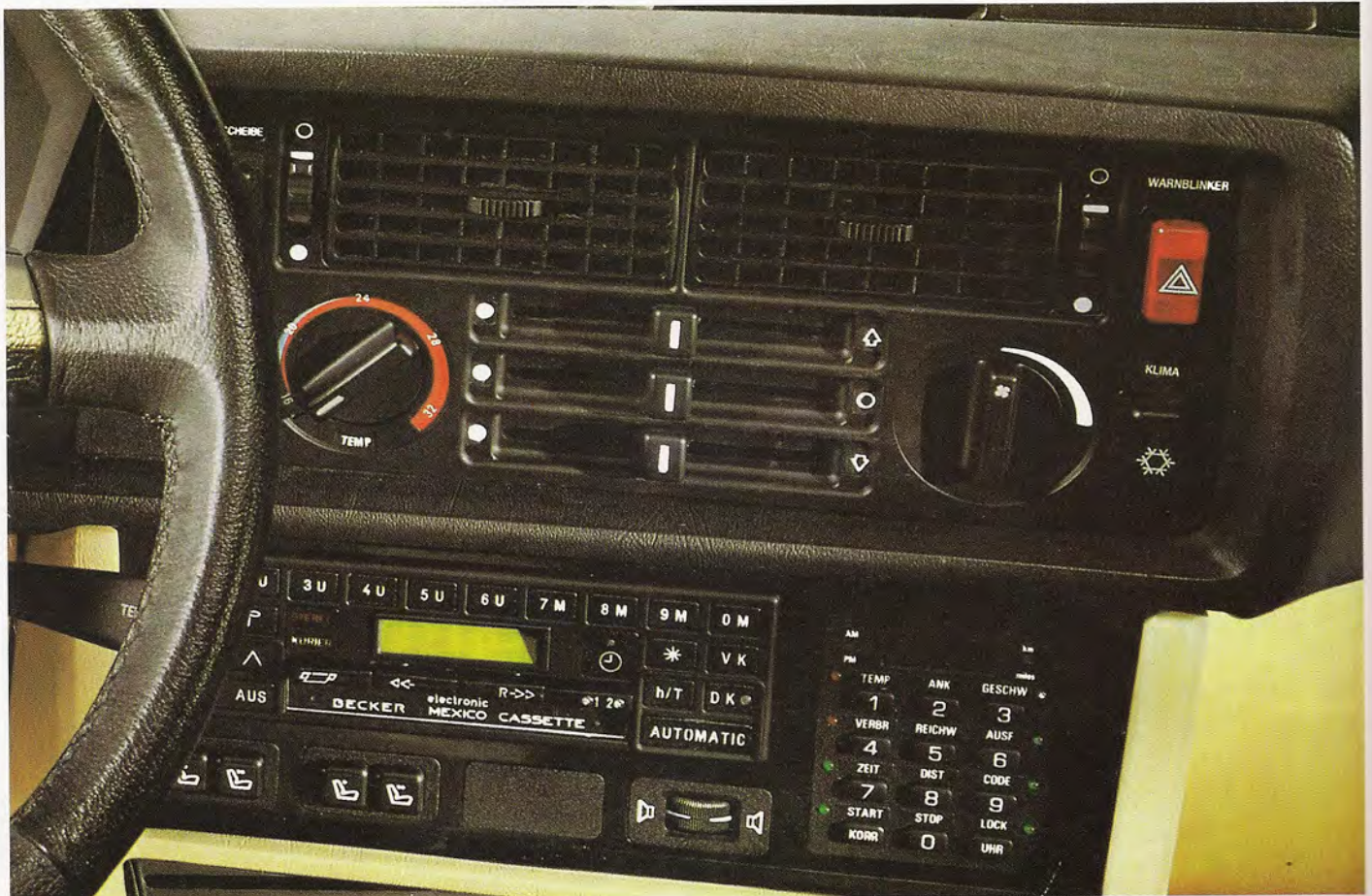
El ordenador de a bordo de algunos modelos BMW ejecuta diez funciones que van desde el control de la temperatura exterior, hasta el ahorro de gasolina, pasando por la creación y almacenamiento de un código antirrobo.
