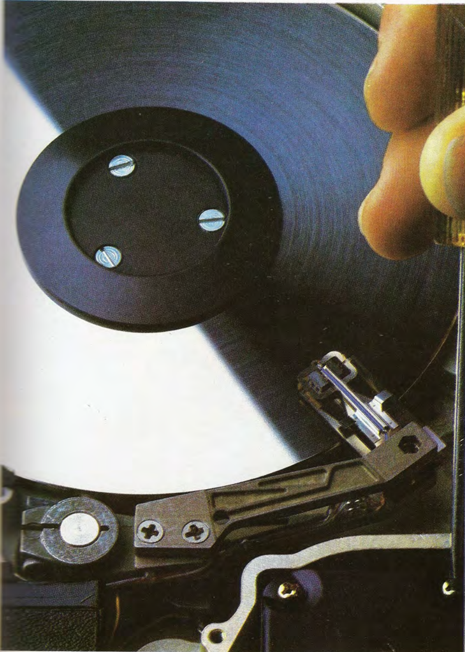
Detalle de la cabeza lectora de una unidad de disco rígido.
