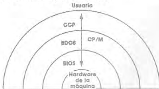
Estructura por capas de CP/M.
