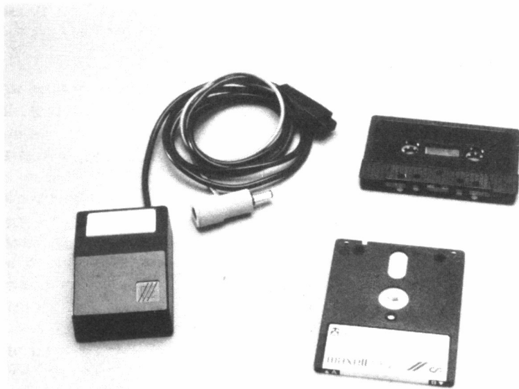
■ 21.1.12. El joystick es un periférico de toma de información especialmente destinado a los juegos de acción.
