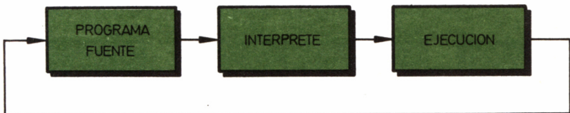
21.2.3. Esquema de funcionamiento de un intérprete.
