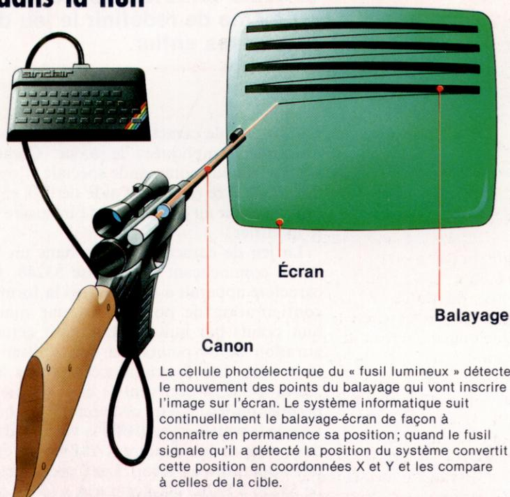
La cellule photoélectrique du « fusil lumineux » détecte le mouvement des points du balayage qui vont inscrire l'image sur l'écran. Le système informatique suit continuellement le balayage-écran de façon à connaître en permanence sa position; quand le fusil signale qu'il a détecté la position du système convertit cette position en coordonnées X et Y et les compare à celles de la cible.
