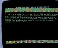
Contrairement à la plupart des autres micro-ordinateurs, Enterprise offre un programme de traitement de texte intégré. L'ordinateur l'exécute automatiquement si aucune cartouche n'est installée. Ce programme peut être utilisé en mode 40 ou 80 colonnes.
