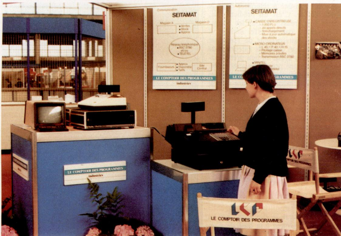
L'ensemble SEITAMAT, présenté au Spécial Sicob 1985 par Le Comptoir des programmes (L.C.P.), comporte un terminal de vente Strator 20, le micro-ordinateur Strator 200 et un Minitel pour la commande et l'affichage. (Photo L.C.P.)
