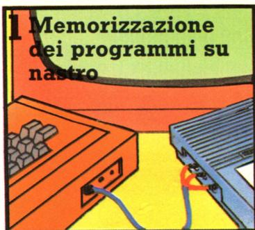
Collega il registratore al computer seguendo le istruzioni del manuale. Per evitare interferenze, controlla che i cavi non si incrocino.
