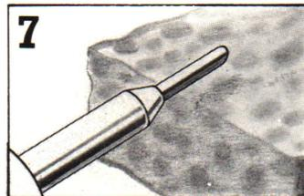
Dopo ogni saldatura, pulisci la punta sulla spugna umida e ricorda di staccare il saldatore quando hai finito.
