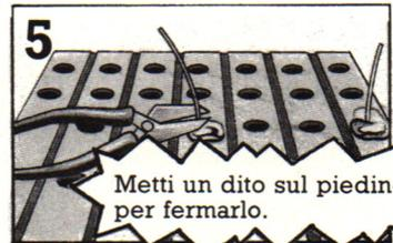
Fai raffreddare la saldatura, poi inclina la scheda allontanandola da te e taglia i piedini vicino alla saldatura usando un tagliafilo.
