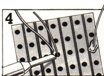
Tocca il piedino della componente con la punta del saldatore e l'estremità dello stagno per un secondo, finché una goccia di stagno si attacca alla traccia.
