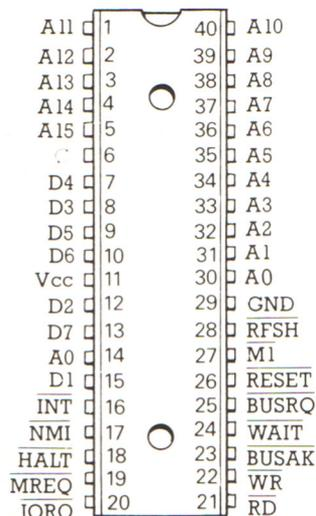
**A0-A15** Questi piedini trasportano i codici di indirizzo a 16 bit che escono dal microprocessore. A sta per *address* (indirizzo) e il numero si riferisce alla posizione del bit nel codice.
