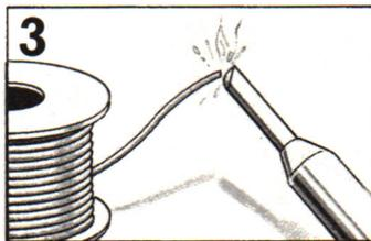
Con la punta calda del saldatore, tocca l'estremità dello stagno in modo che se ne sciolga una goccia e rimanga attaccata alla punta.
