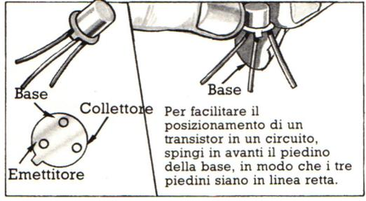
Per facilitare il posizionamento di un transistor in un circuito, spingi in avanti il piedino della base, in modo che i tre piedini siano in linea retta.
