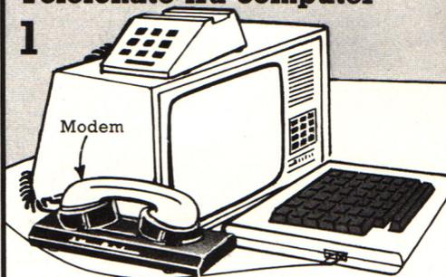
I computer possono essere collegati fra loro tramite telefono e un'apparecchio chiamato modem\*, che trasforma i segnali in linguaggio macchina in segnali elettronici trasferibili su linee telefoniche.
