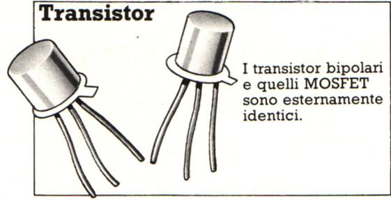
I transistor bipolari e quelli MOSFET sono esternamente identici.
