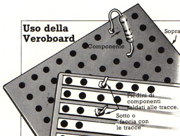
La Veroboard è stata appositamente progettata per costruire semplici circuiti elettronici. Ha file di fori, collegati fra loro da tracce di rame sul retro. I piedini delle componenti e i fili provenienti da una pila vengono inseriti nei fori e saldati al rame, così che la corrente può scorrere fra le componenti lungo le tracce. Le dimensioni di una Veroboard sono date dal numero di tracce per quello dei fori su ciascuna traccia (per es.: 10 tracce x 24 fori).
