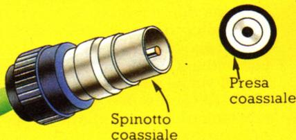
Uno spinotto coassiale è costituito da una punta circondata da un collare metallico. Il cavo racchiude due fili: uno è collegato al puntale, l'altro al collare. È generalmente usato a connettere, un computer ad un apparecchio TV o ad un monitor.
