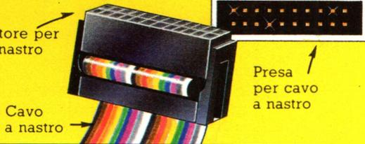
Un connettore a nastro è costituito da un corpo plastico con due file parallele di aperture, esso si innesta su un apposito zoccolo costituito da due file di punte. Il cavo piatto collegato è chiamato 'nastro', ed è costituito da di fili affiancati ed isolati. I cavi a nastro trasportano segnali paralleli.
