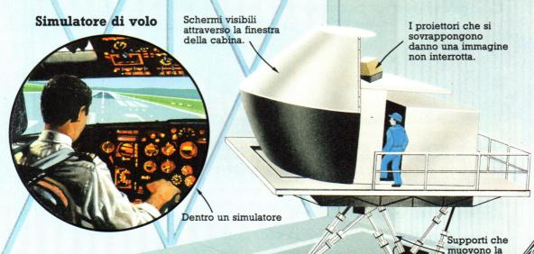
Un simulatore di volo è un modello controllato da un computer del ponte di volo di un aeroplano. Il computer proietta immagini in 3-D in movimento di una pista sugli schermi attorno alla cabina e risponde in tempo reale al pilota in addestramento che sta ai comandi, simulando anche le sensazioni di decollo di virata e di atterraggio, effetti sonori compresi. Può
