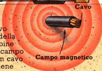
sua volta, induce nelle bobine del robot una debole corrente elettrica, la cui forza varia a seconda della distanza fra robot e cavo: il computer guida il robot equilibrando la forza della corrente nelle due bobine.
