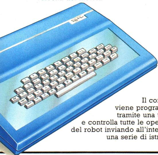
Il computer viene programmato tramite una tastiera e controlla tutte le operazioni del robot inviando all'interfaccia una serie di istruzioni.
